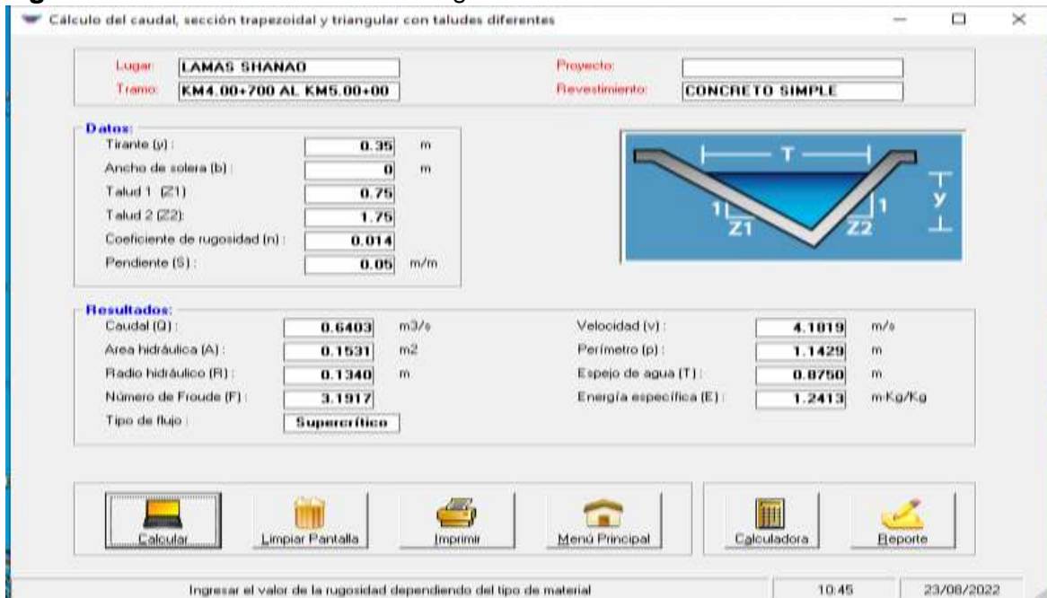
Figura N° 10: Diseño de cuneta triangular asimétrica 2006.
