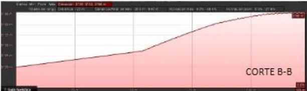
El terreno del terminal es de tipo irregular, la topografía de la zona es accidentada con una pendiente máxima de 7.5% y una mínima de 0.0%; es por ellos que el terminal es diseñado en varias secciones adaptándose a su entorno.
