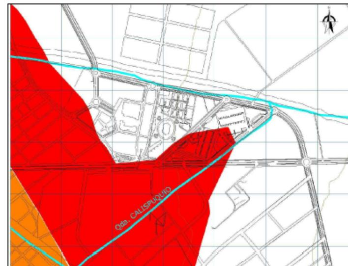
El terreno, se ubica en una zona de peligro general alto, por encontrarse en la zona del valle cercana a un río y quebrada, y parte baja de la ciudad de Cajamarca; por lo cual, es necesario tener un diseño estructural que refuerze la arquitectura del terminal que ayude a eliminar cualquier tipo de vulnerabilidades.
