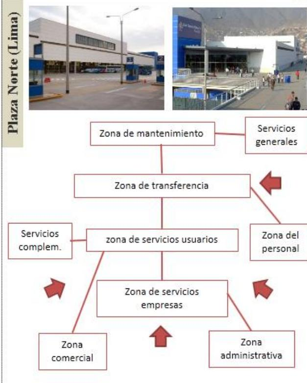
El diagrama de zonificación del terminal es regular y con ambientes ordenados entre si y fácilmente visibles; se siguen secuencias e interacción de ambientes
