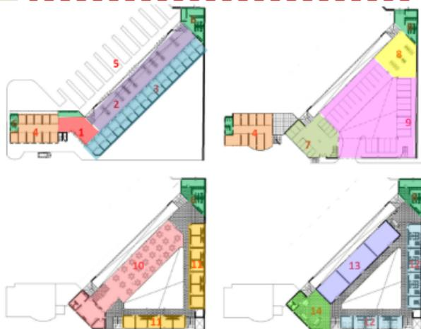
La programación del terminal esta dividida en siete ambientes exteriores y catorce ambiente interior, los cuales se encuentran repartido en un bloque de cuatro niveles zonificado según la función específica que cumplan.
