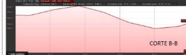
El terreno del terminal es de tipo irregular, la topografías muy accidentada en su corte, tenidos así varios niveles de pendientes, la pendiente máxima es de 9.7% y la mínima de 4.7%; por ellos el diseño es adaptando al nivel mas alto
