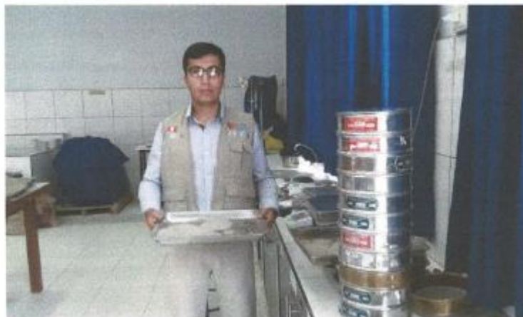
En la imagen se aprecia la realización del tamizado el cual tomara entre unos 10 a 15 minutos
