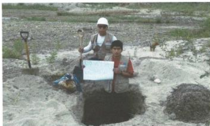
En la imagen se aprecia la realización de la calicata para la toma de muestra a una profundidad de 1.00 m
