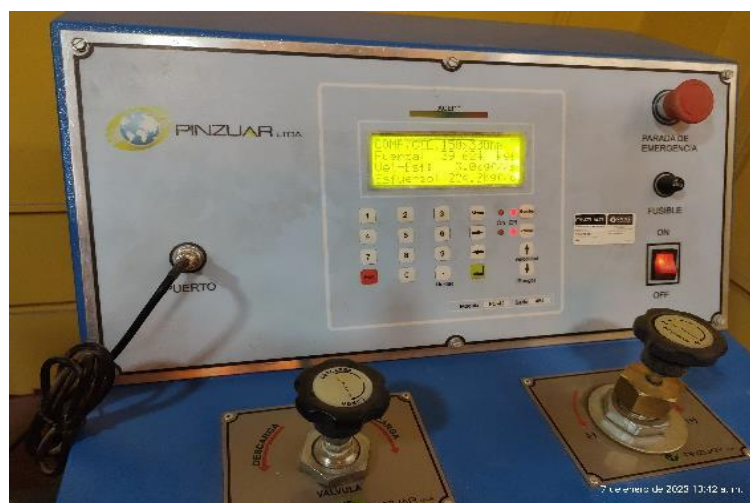
Lectura de Resultado de Prueba de Compresión
