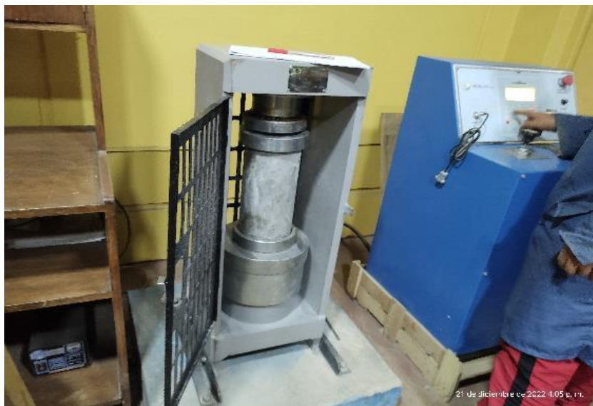
Probetas en Máquina de Compresión
