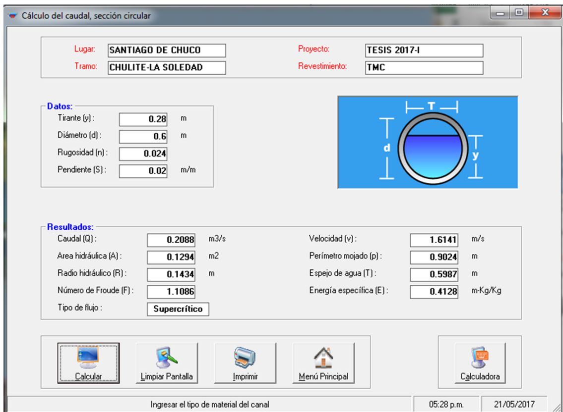
FIGURA N°05: Cálculo hidráulico de alcantarilla
