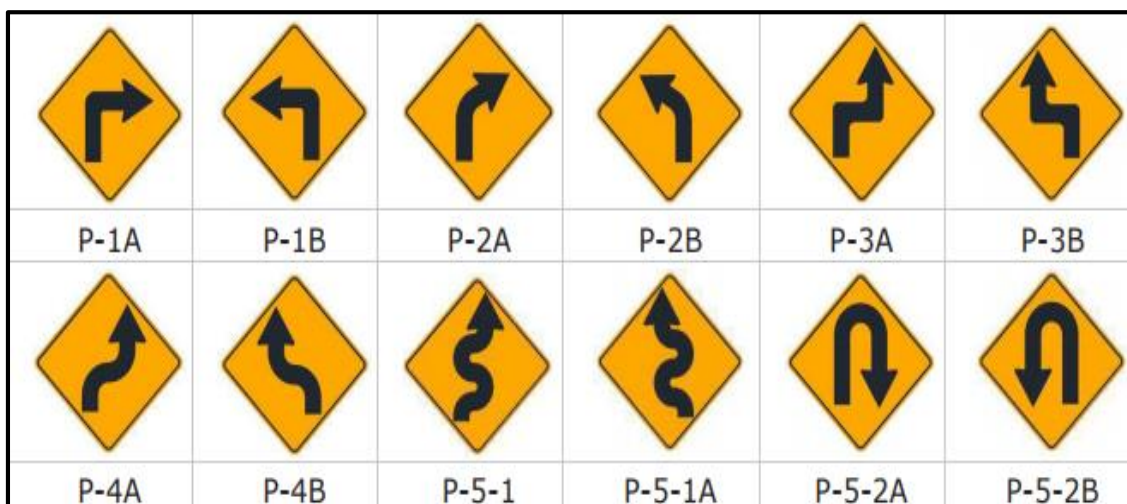
FIGURA N°26: Señales preventivas curvatura horizontal
