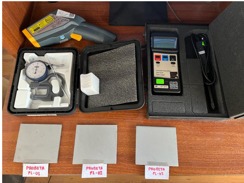
Fotografía de equipos y probetas para realizar la inspección de perfil de anclaje.
