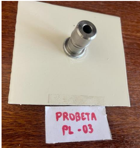
Fotografía de valor medido a la Probeta PL-03: 2000 PSI
