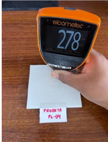
Fotografía de valor medido a la Probeta PL-04
