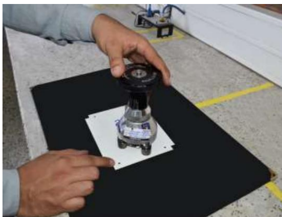
Figura N°02: Ensayo de adherencia por tracción.
