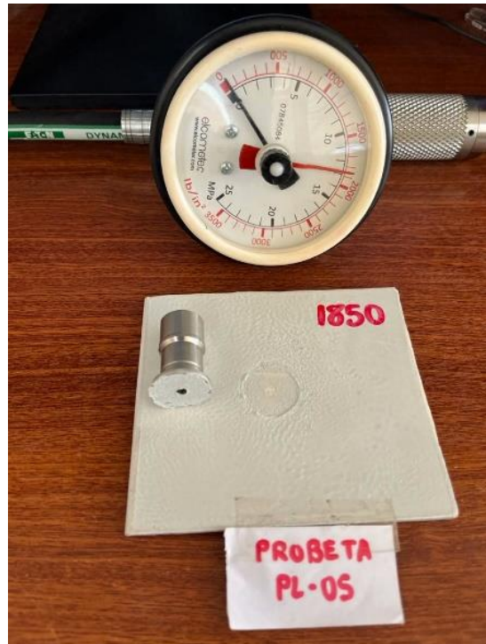
Fotografía de valor medido a la Probeta PL-05: 1850 PSI
