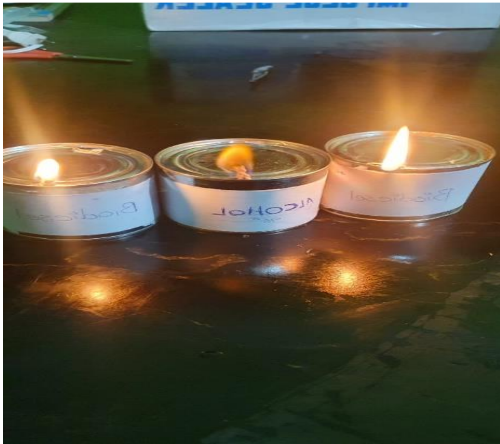
Figura 24. Inflamabilidad y duración de Biodiesel y alcohol 96° en mechero de lata
