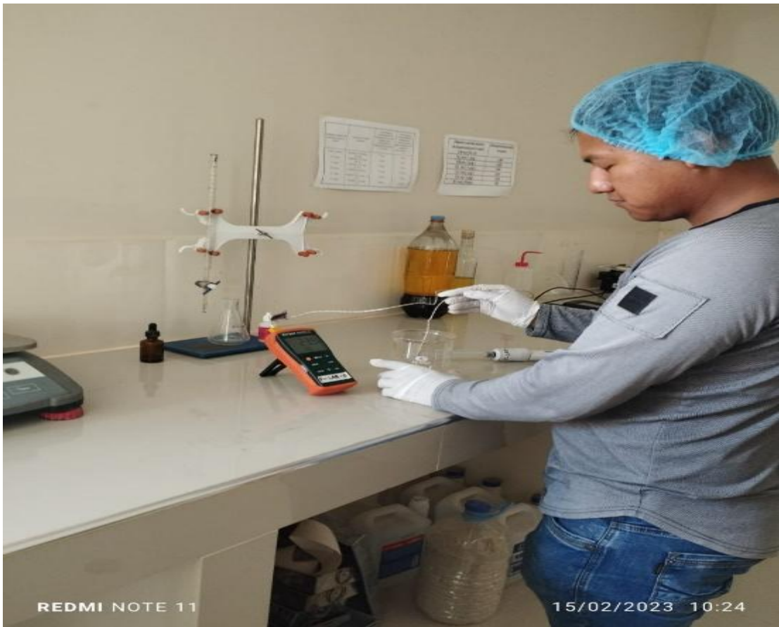
Figura 25. Medición de temperatura en aceite usado de cocina
