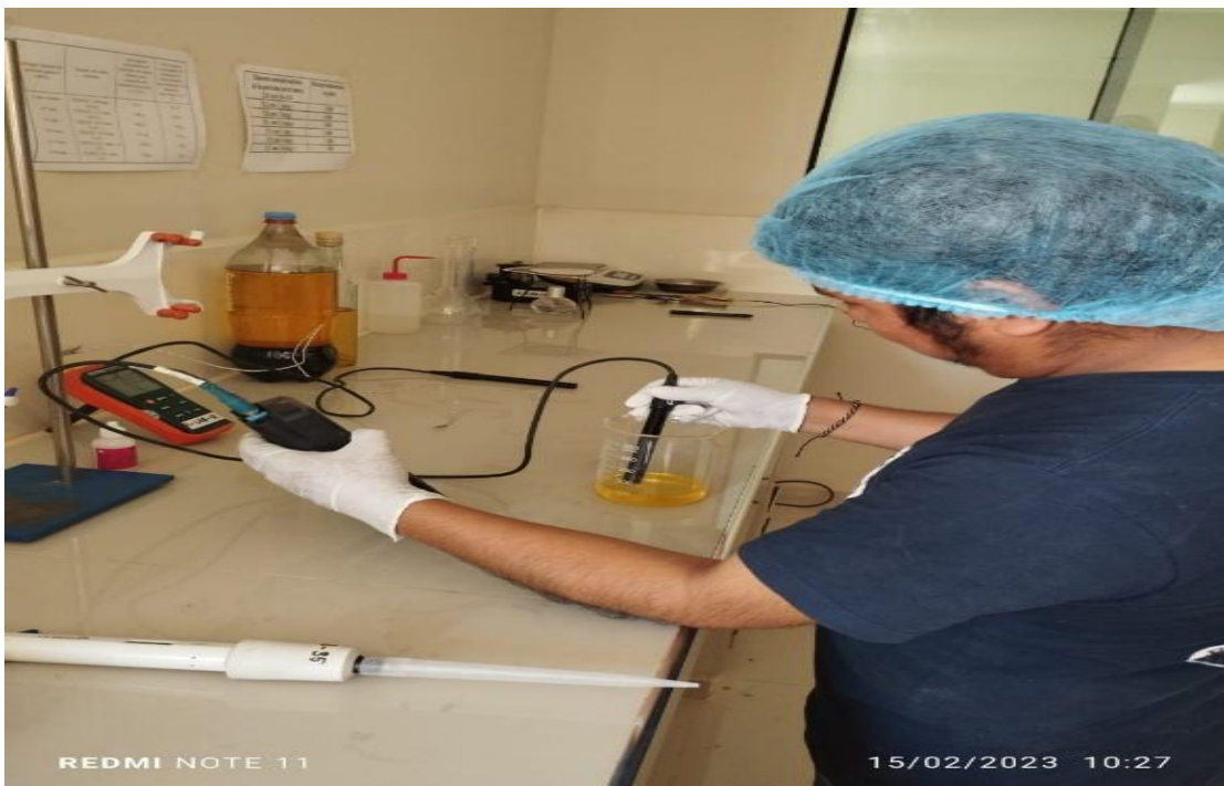
Figura 26. Medición de Ph de aceite usado de cocina
