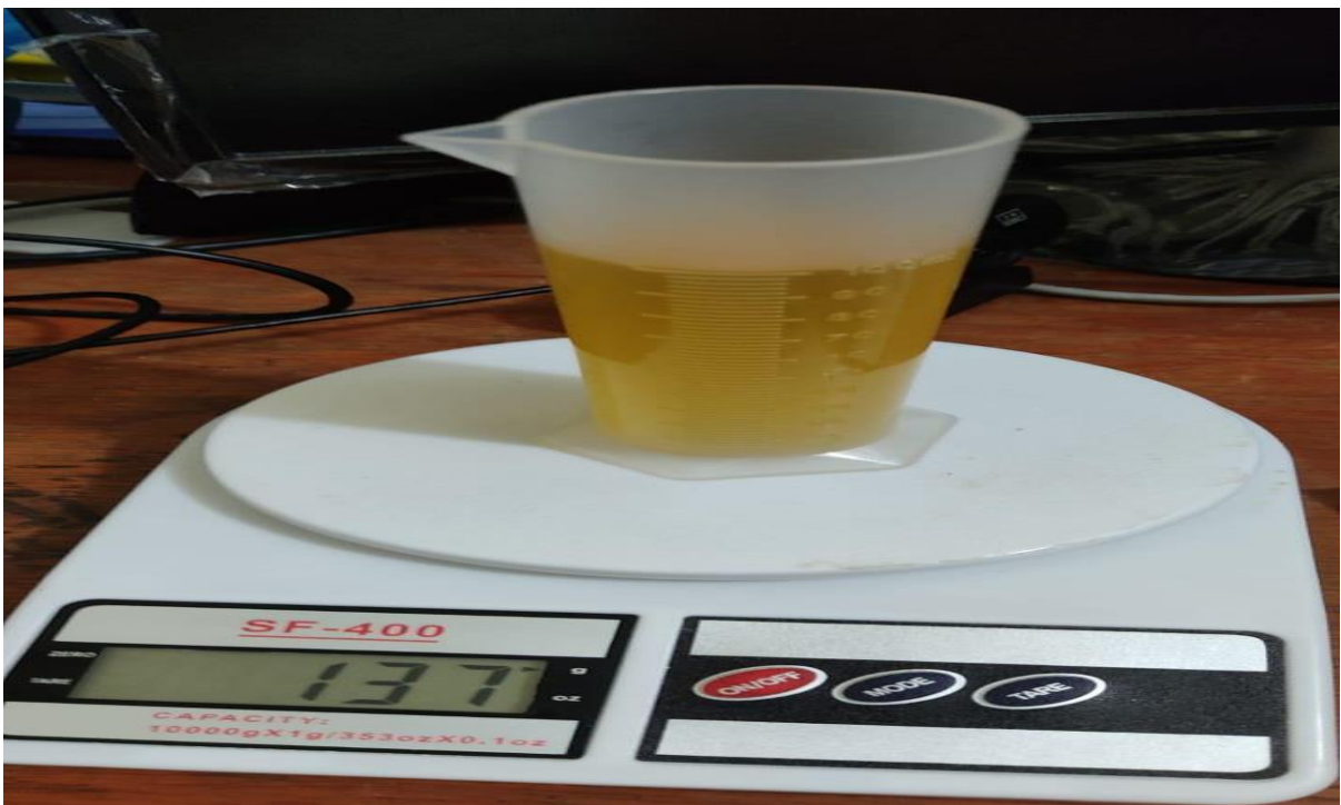
Figura 22. Muestra análisis de densidad al Biodiesel
