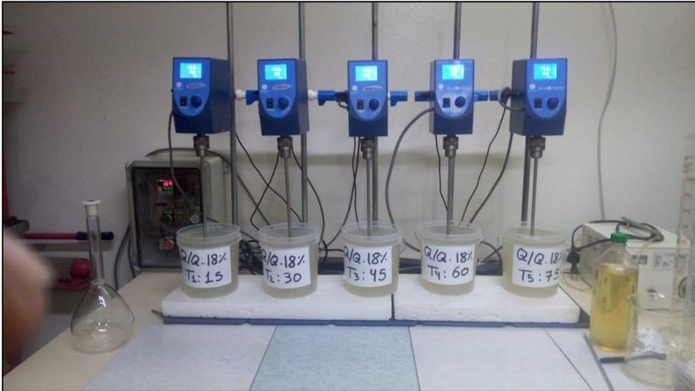
Figura 38. Preparación del tratamiento con 100 rpm en los seis tiempos.
