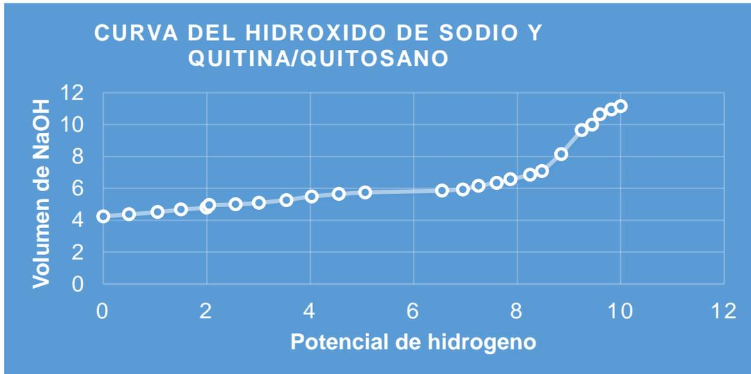
Figura 8. Curva de la titulación con hidróxido de sodio 0.05M.
