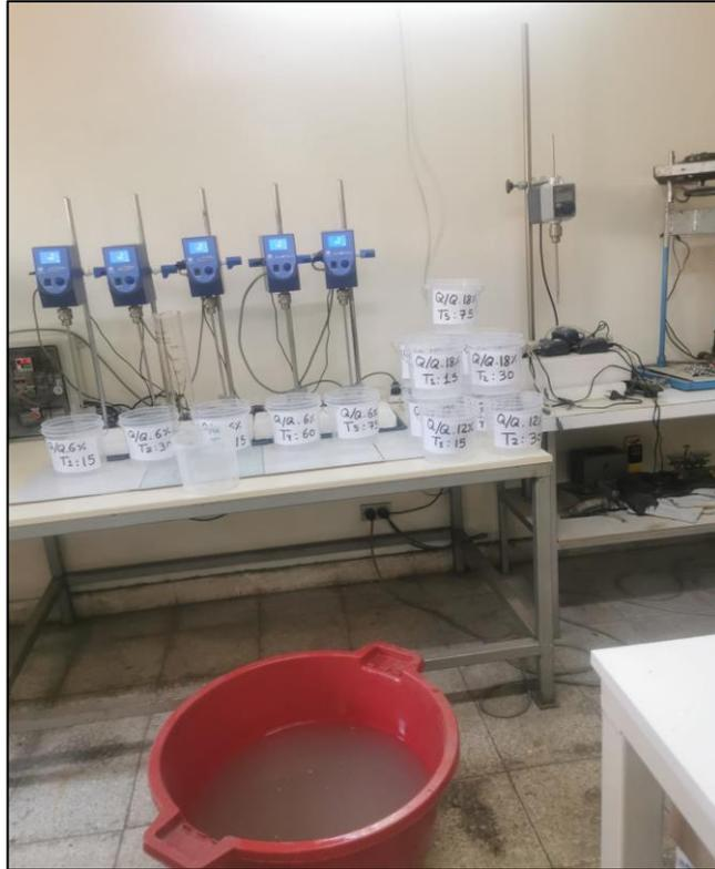
Figura 36. Preparación del agua residual por los tratamientos.
