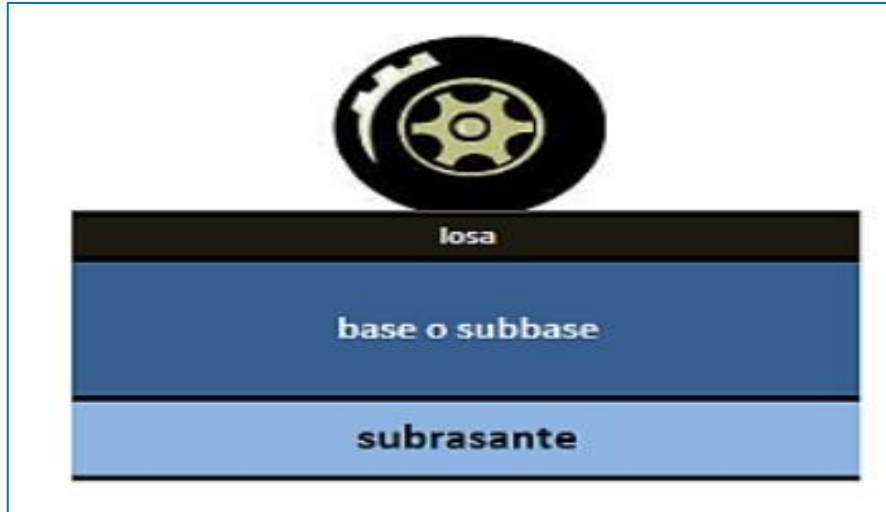
Figura 1. Sección típica transversal pavimento rígido
