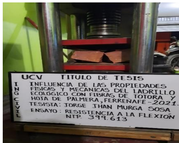
Figura 36. Proceso de elaboración del ensayo de resistencia a la flexión.
