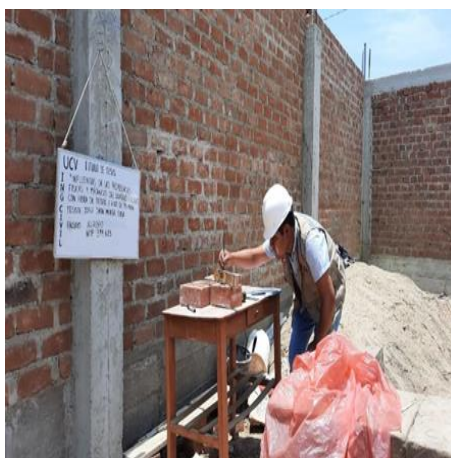
Figura 28. Proceso de elaboración del ensayo de alabeo.
