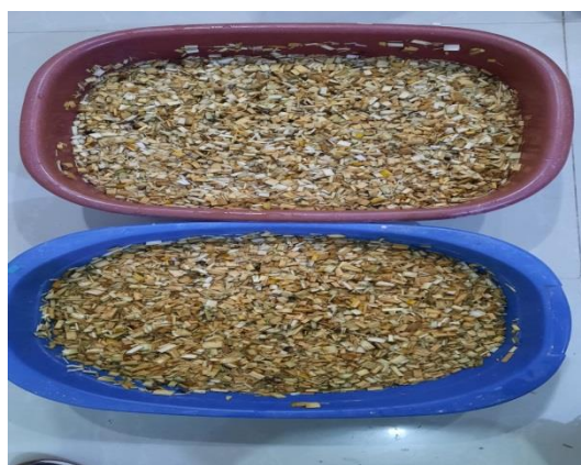
Figura 13. Lavado de Totora con agua destilada y cal.
