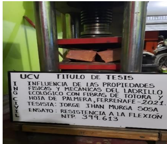
Figuras N°15. Ensayo de Resistencia a la Flexión.
