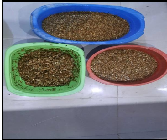
Figura 16. Lavado de Totora con agua destilada y cal.
