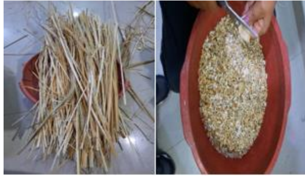
Figura 14. Deshilachado y triturado de hoja de totora.
