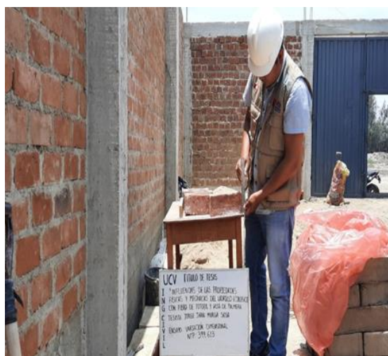
Figura 27. Proceso de elaboración del ensayo de Variación dimensional.
