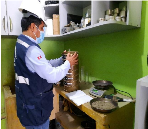
Figuras N°05. Ensayo de Análisis granulométrico. Figuras N°06. Combinación de los materiales Arcilla-limo, Arena y Totora/Palmera.
