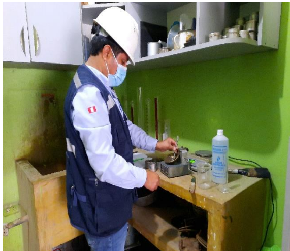
Figuras N°04. Ensayo Limite Liquido y Limite Plástico.
