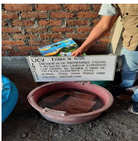
Figura 31. Proceso de elaboración del ensayo de Absorción.
