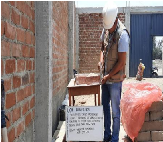
Figuras N°11. Ensayo de Variación Dimensional.
