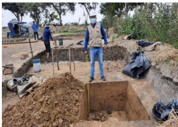
Figura 23. Muestreo de calicata en cantera.
