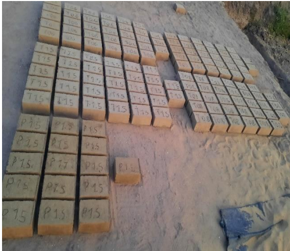
Figuras N°09. Proceso de secado de ladrillo.
