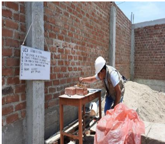
Figuras N°12. Ensayo de Alabeo.
