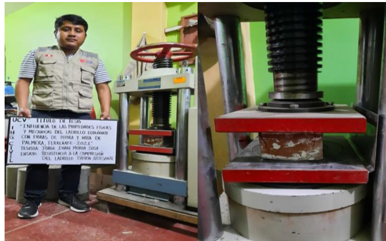
Figura 34. Proceso de elaboración del ensayo de resistencia a la compresión axial ( f'b ).
