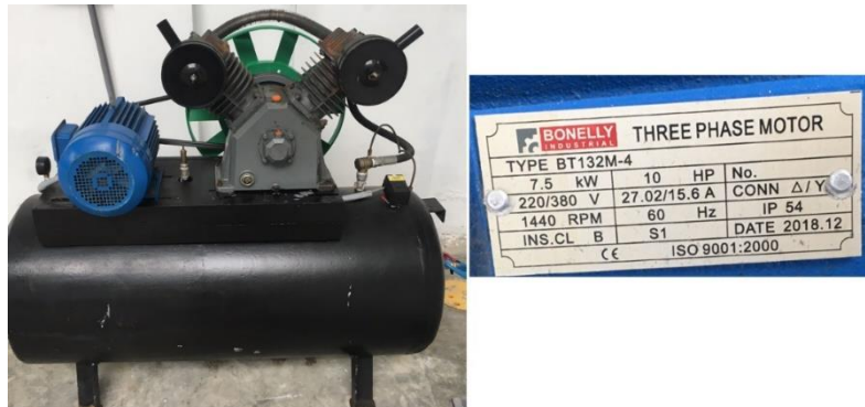
Figura 34. Ficha técnica del compresor neumático.
