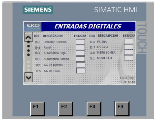
Figura 41. Entradas digitales mostrada en HMI.
