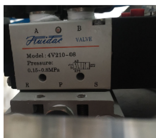
Figura 33. Ficha técnica de la válvula 1/4 neumático solenoide 5/2.
