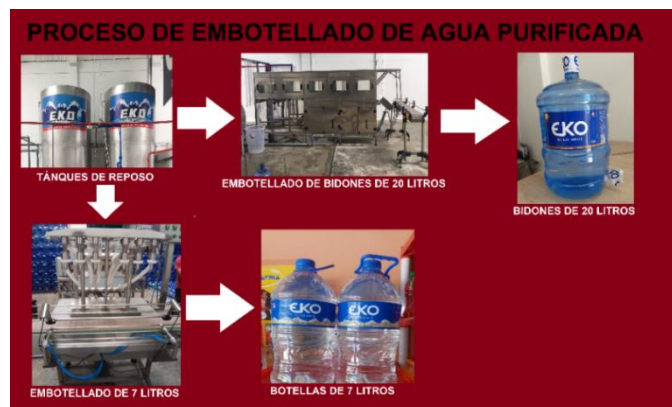
Figura 1. Proceso de embotellado de agua purificada.
