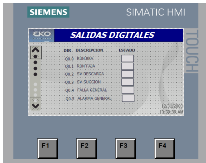
Figura 42. Salidas digitales mostrada en HMI.
