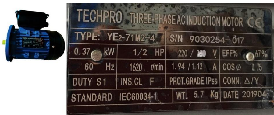
Figura 35. Ficha técnica del motor.
