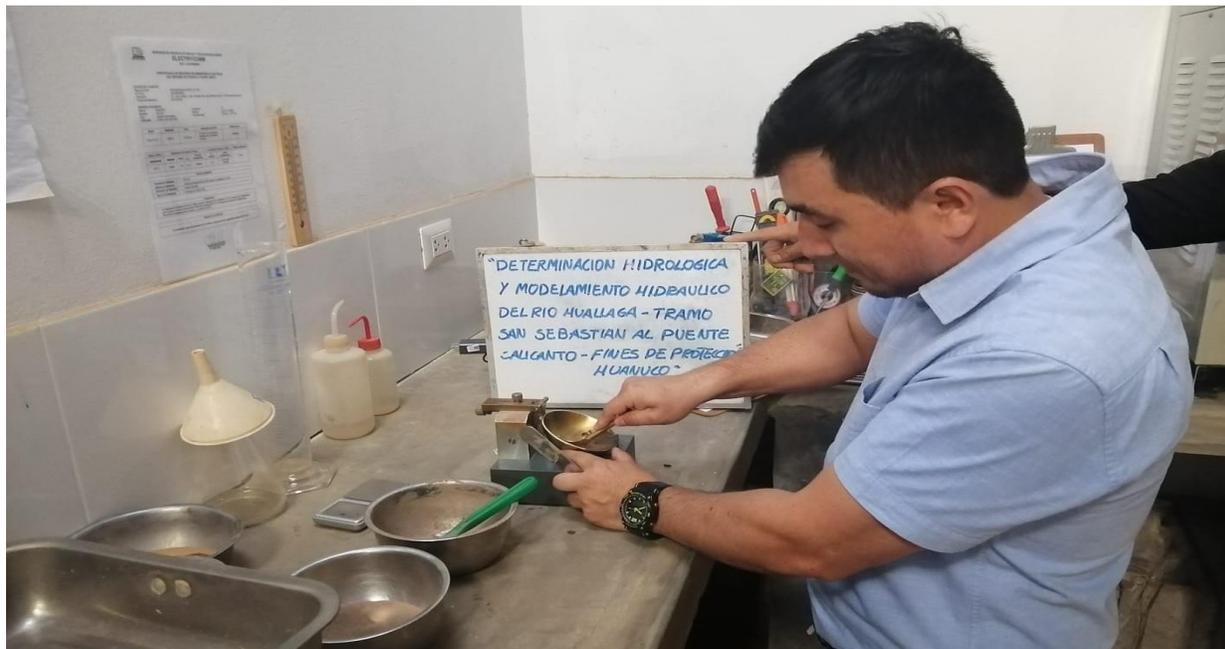
Foto N° 08: Realizando el ensayo Limite Liquido – Copa Casagrande.
