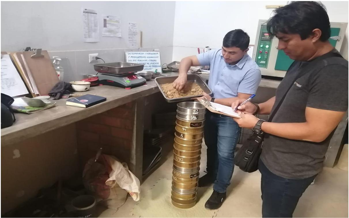
Foto N° 07: Se observa los trabajos en laboratorio, realizando el ensayo de granulometría.
