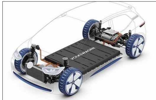
Figura 5 Vehículo Eléctrico de Batería (VEB)
