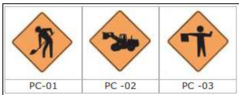
Figura 021. Señales de prevención según zonas de trabajo.
