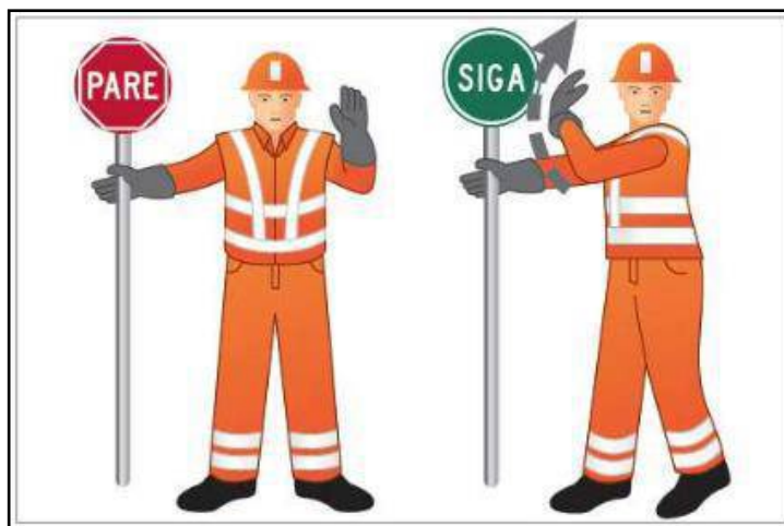
Figura 4. Banderillero con señales portátiles reglamentarias "PARE" y "SIGA" según zonas de trabajo.
