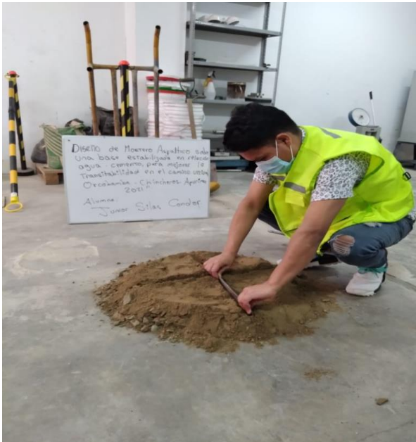
Fotografía 3: Muestra extraída de las calicatas
