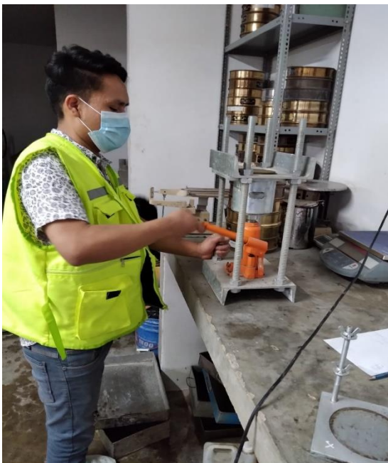
Fotografía 11: Extracción de probeta con la gata hidráulica
