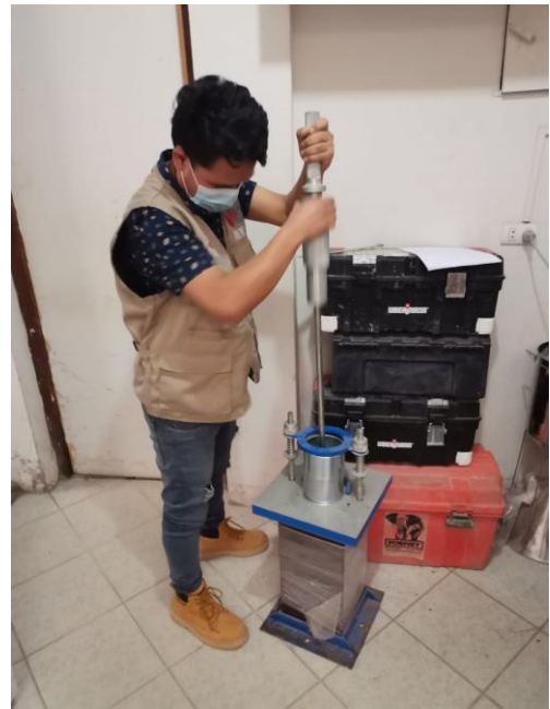
Fotografía 20: Compactación del mortero asfáltico con el martillo Marshall
