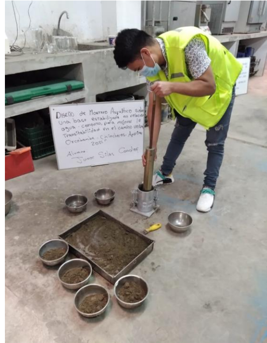
Fotografía 10: Compactando las probetas suelo – cemento
