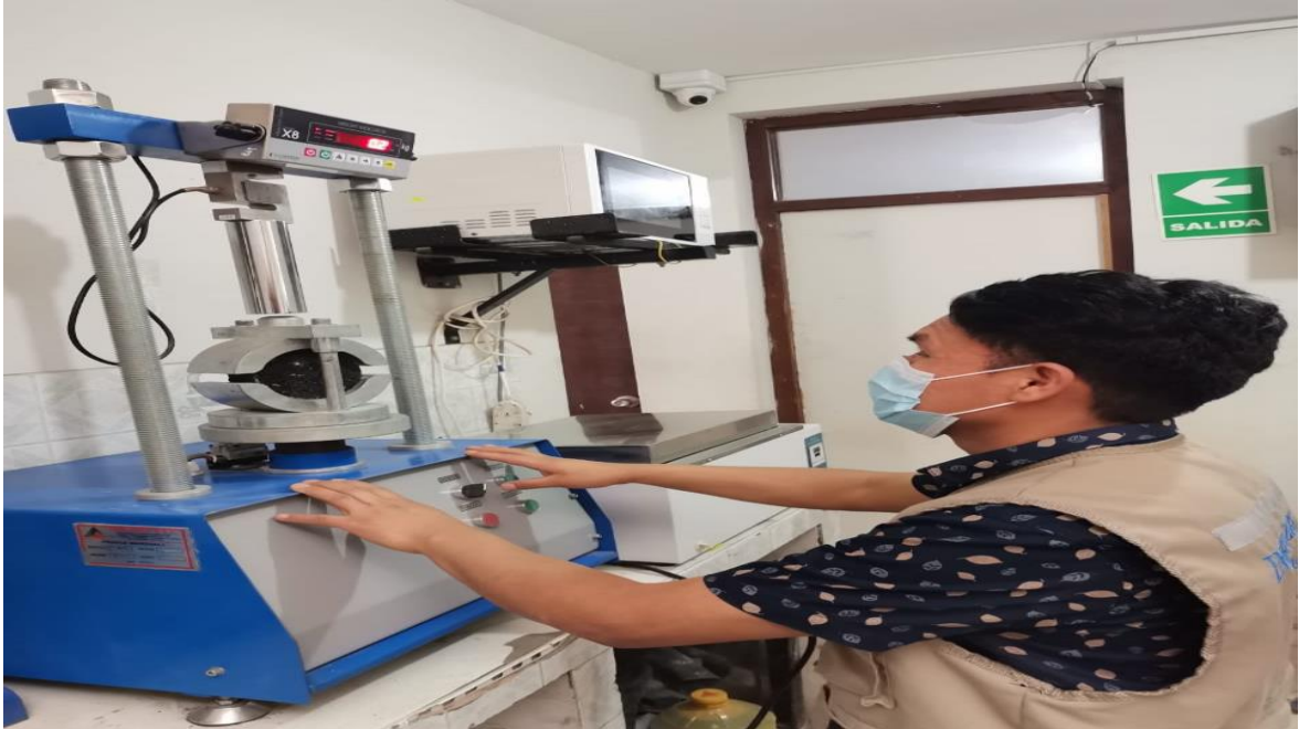
Fotografía 27: Flujo del mortero asfáltico con el equipo Marshall
