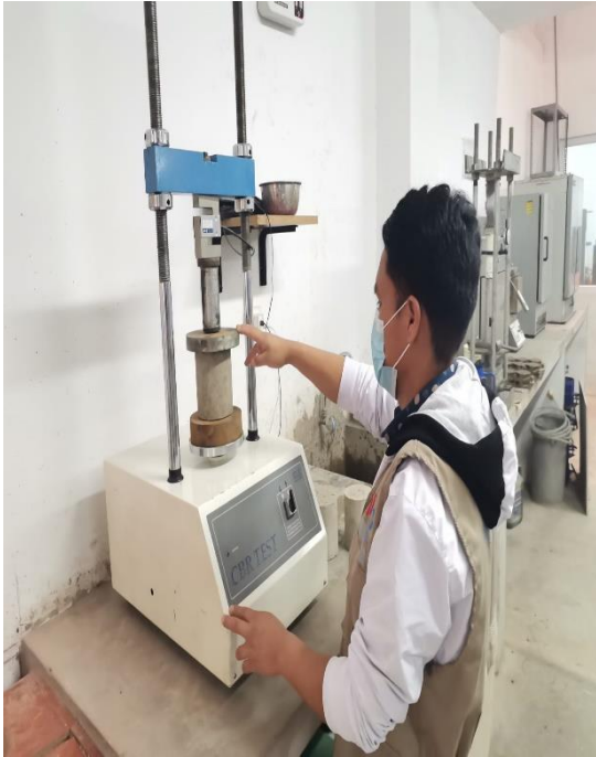
Fotografía 13: Ensayo de compresión a la probeta suelo - cemento
