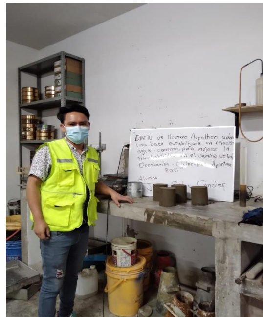
Fotografía 12: Probetas suelo – cemento
