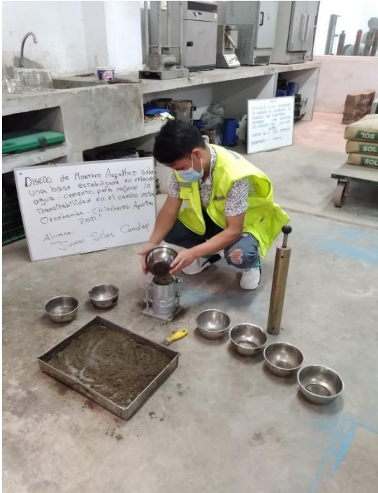
Fotografía 9: Preparando las probetas suelo – cemento
