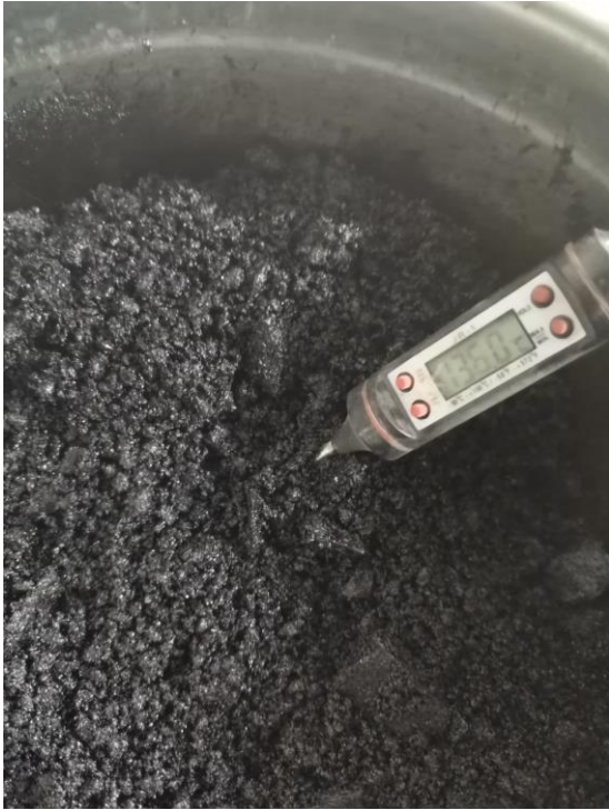
Fotografía 17: Temperatura del mortero asfáltico
