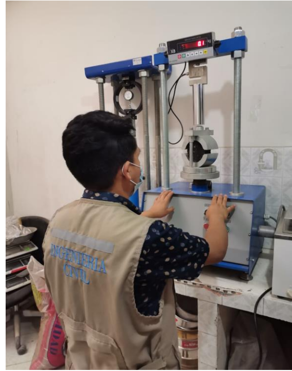
Fotografía 26: Estabilidad del mortero asfáltico
