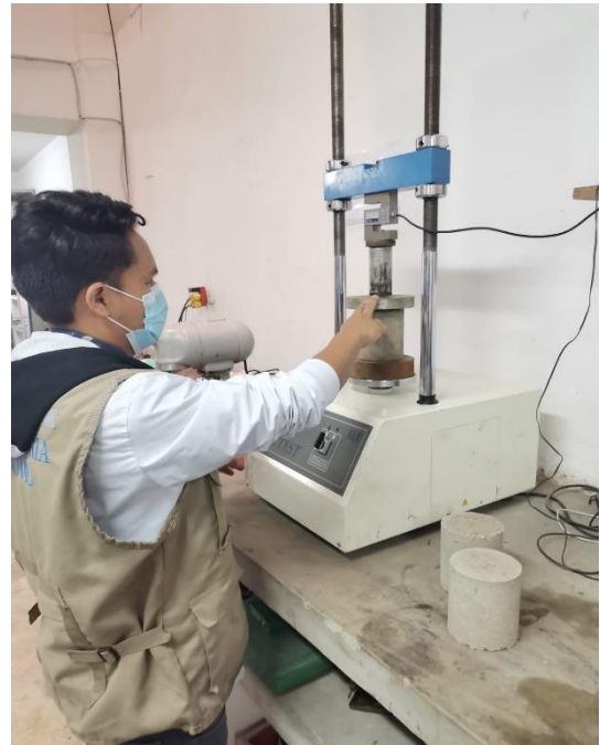
Fotografía 14: Verificando la resistencia máxima de compresión de la probeta
