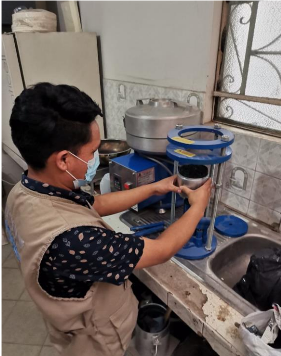
Fotografía 21: Retiro de la probeta cilíndrica con la gata hidráulica
