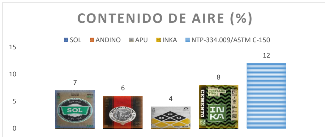
Figura 2: "Contenido de Aire de Cemento Comercial vs NTP-334.009/ASTM C-150"
