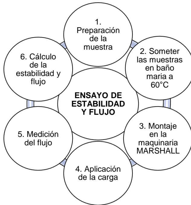
Figura 11. Procedimiento de utilización de la prensa Marshall.
