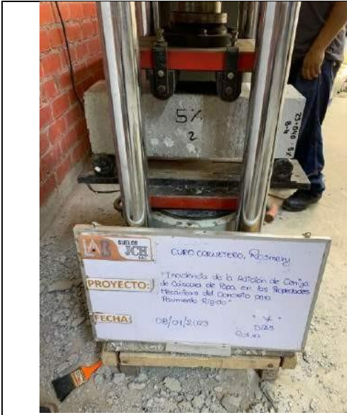
Ensayo de resistencia a la flexión
