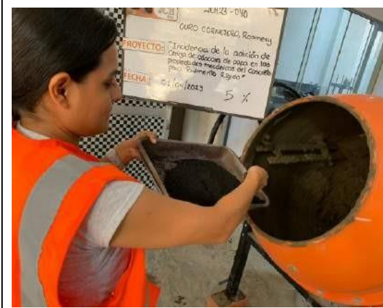
Reemplazo de cemento por ceniza de cáscara de papa al 5%
