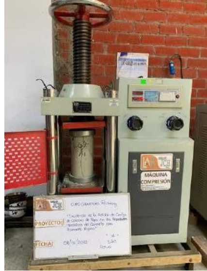
Ensayo de resistencia a la compresión
