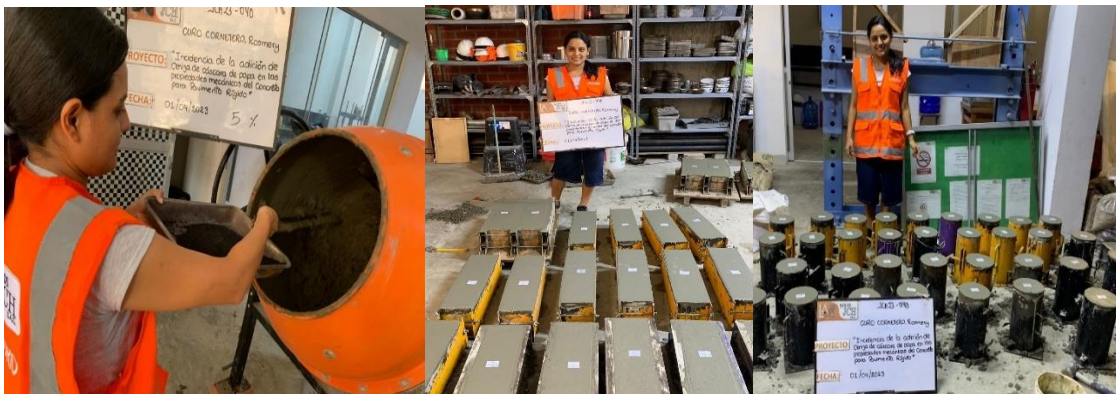
Figura 3. Reemplazo de la ceniza de cáscara de papa en el diseño de mezcla
