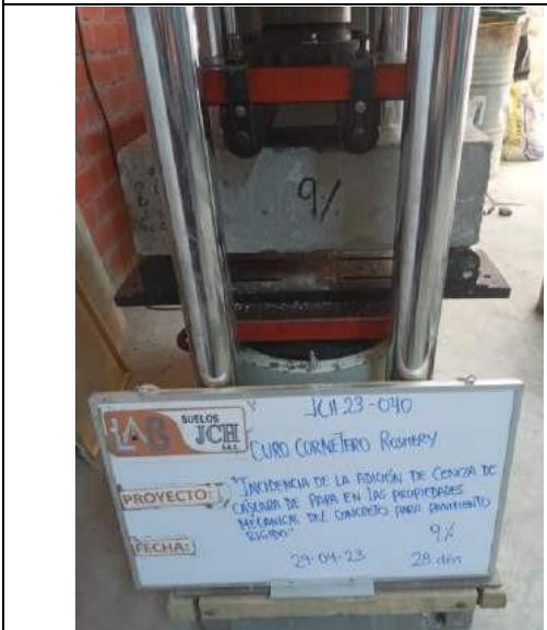
Ensayo de resistencia a la flexión
