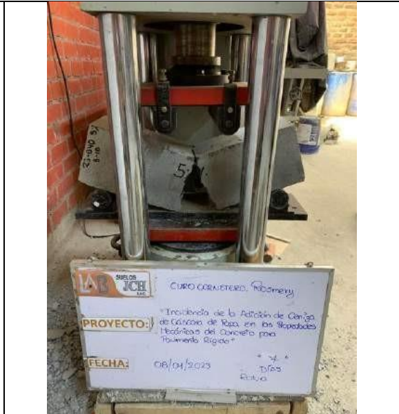
Ensayo de resistencia a la flexión
