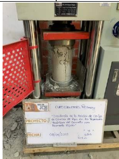
Ensayo de resistencia a la compresión
