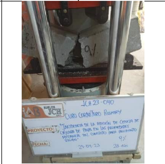
Ensayo de resistencia a la flexión
