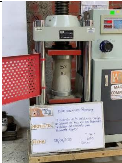
Ensayo de resistencia a la compresión
