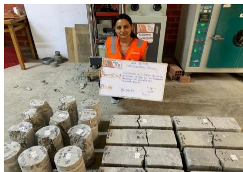
Figura 4. Rotura de las probetas
