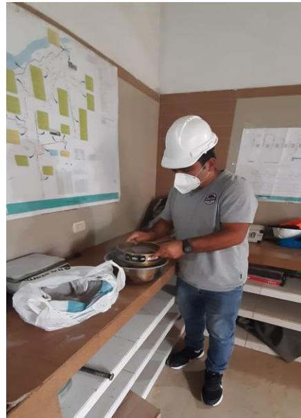
Ensayo de análisis granulométrico de agregados en el laboratorio
