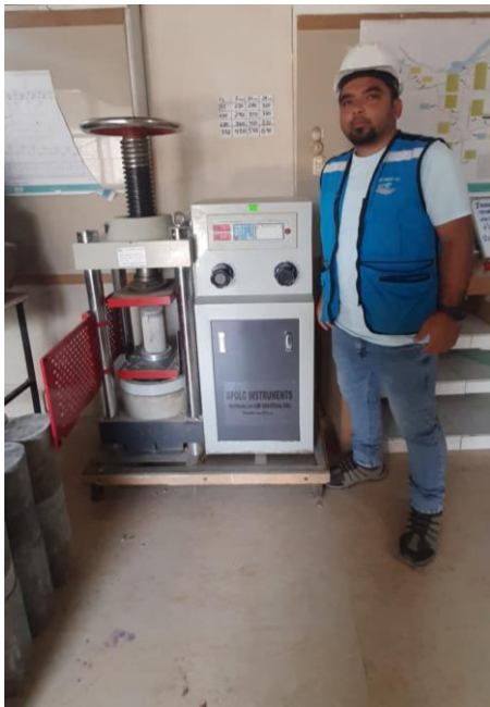
Rotura de probetas de concreto (Resistencia a la compresión de cilindros ASTM C-39)
