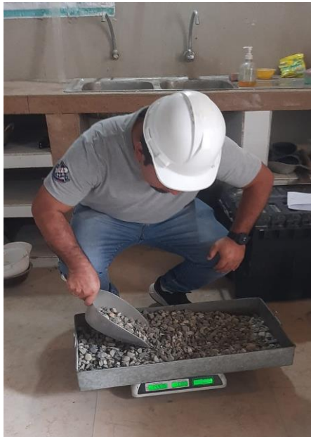
Ensayo de análisis granulométrico de agregados en el laboratorio
