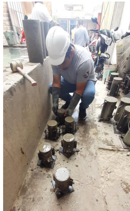
Elaboración de probetas de concreto (NTP 339.033)
