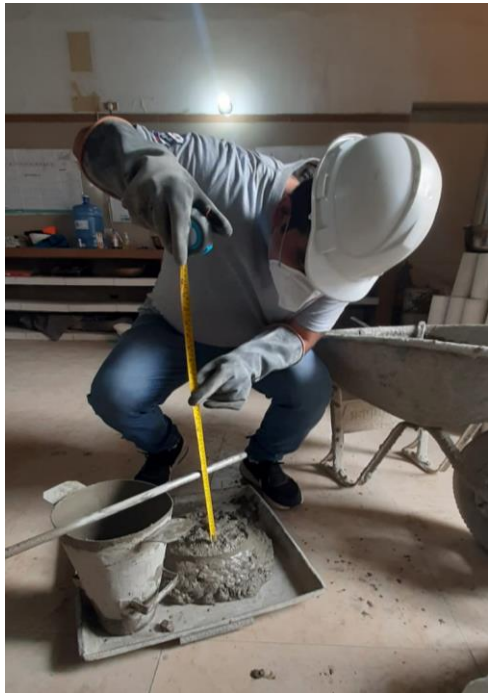
Ensayo de asentamiento para determinar la trabajabilidad del concreto (Prueba de Slump)
