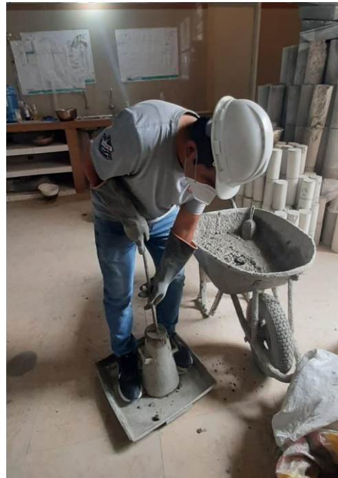
Ensayo de asentamiento para determinar la trabajabilidad del concreto (Prueba de Slump)
