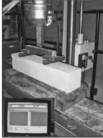
Figura 3. Ensayo de resistencia a la flexión en el punto central
