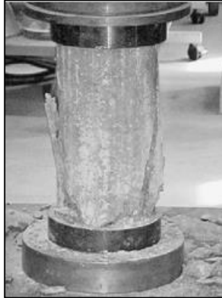
Figura 4. Prueba de resistencia a la compresión.
