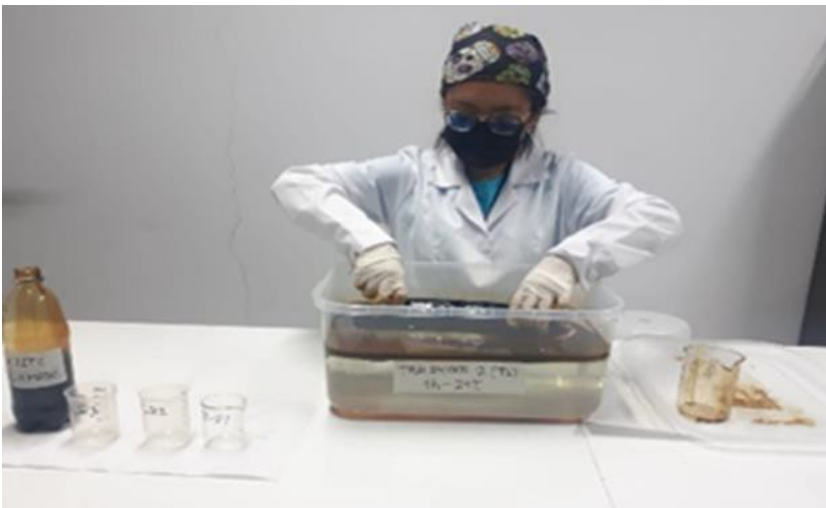
Figura 9: Se introdujo la Stipa Ichu del tratamiento 2, al agua con hidrocarburo.
