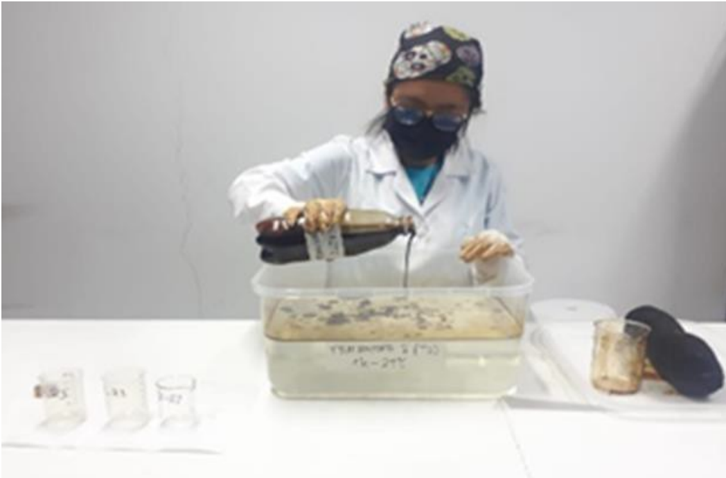
Figura 8: Se vertió el hidrocarburo a 250 ml en 5 Litros de agua.
