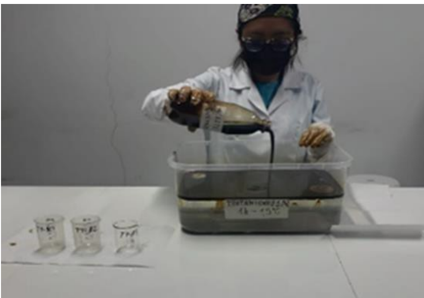
Figura 5: Se vertió el hidrocarburo a 250 ml en 5 Litros de agua.
