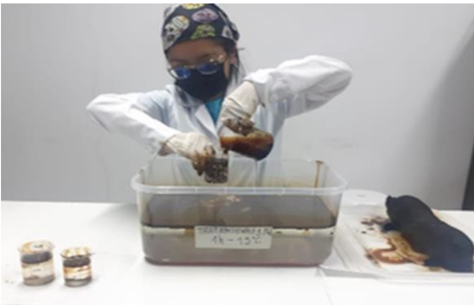
Figura 7: En el tratamiento 1, se procedió a llenar cada réplica de la muestra absorbida por la fibra vegetal en el vaso Beaker (precipitado), R1, R2 y R3, dando como resultado T1R1, T1R2 y T1R3.
