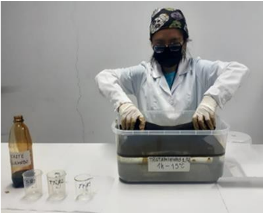
Figura 6: Se introdujo la salchicha de fibra vegetal del tratamiento 1, en el hidrocarburo.
