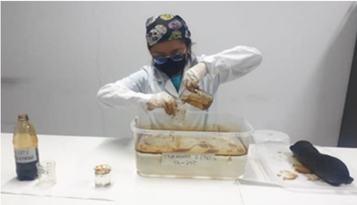
Figura 10: En el tratamiento 2, procedemos a llenar cada réplica de la muestra absorbida en el vaso Beaker (precipitado), R1, R2 y R3, dando como resultado T2R1, T2R2 y T2R3.
