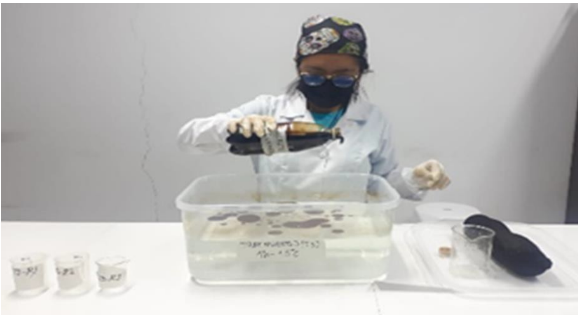
Figura 11: Se vertió 250 ml de HC en 5 Litros de agua.
