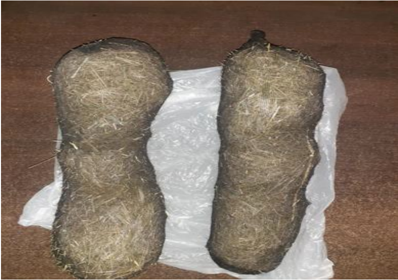
Figura 4: Llenado de biomasa en medias de nylon.
