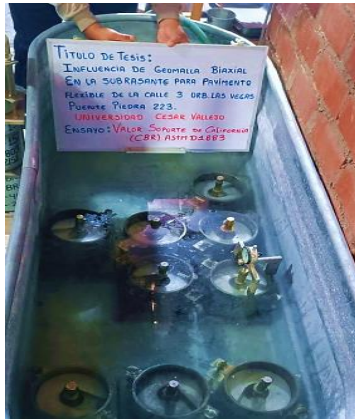
Foto 13: Ensayo de CBR reposo
