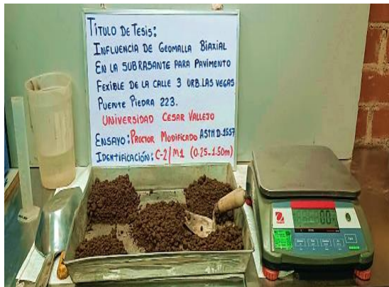
Foto 7: Separación de muestra previo al ensayo de Proctor modificado
