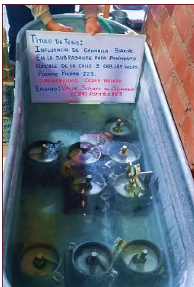
Figura 13. Reposo del ensayo de CBR
