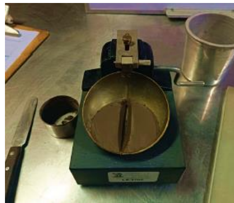
Foto 18: Ensayo de Límites de Consistencia
