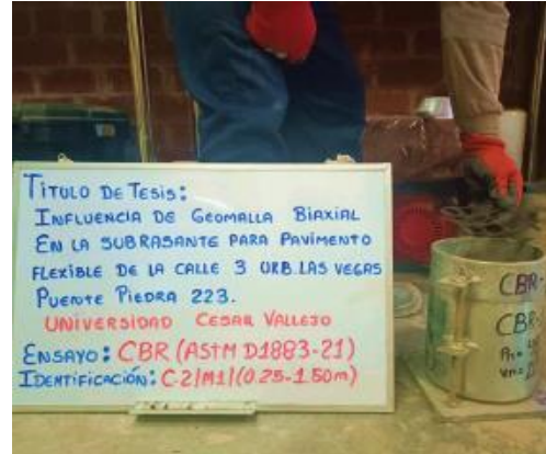
Foto 14: Incorporación de la geomalla en el ensayo de CBR
