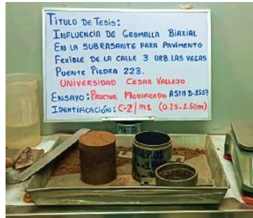
Foto 8: Ensayo de Proctor modificado del terreno patrón
