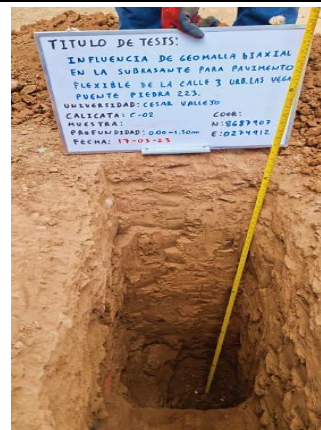
Foto 4: Medición de 1.50 m de profundidad de la calicata 2
