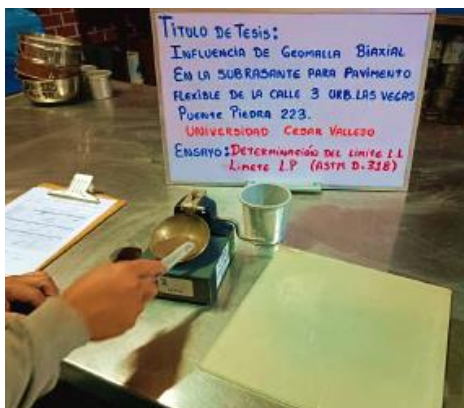
Foto 17: Ensayo de Límites de Consistencia
