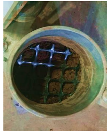
Foto 16: Incorporación de la geomalla en la 1ra capa del ensayo de CBR
