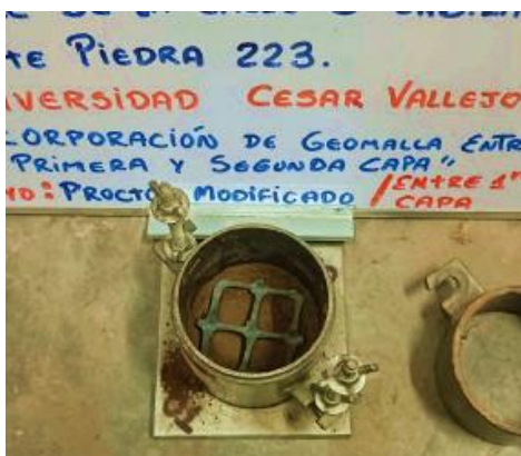
Foto 11: Incorporación de la geomalla en la 1ra capa del ensayo de Proctor modificado
