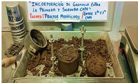
Foto 9: Incorporación de la geomalla en la 2 da capa del ensayo de Proctor modificado
