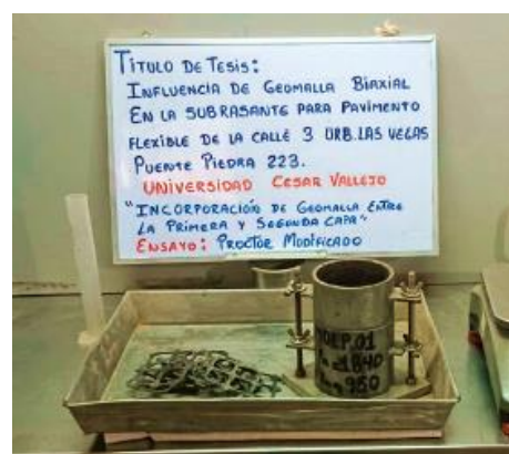
Foto 12: Ensayo de Proctor modificado incorporando las geomallas
