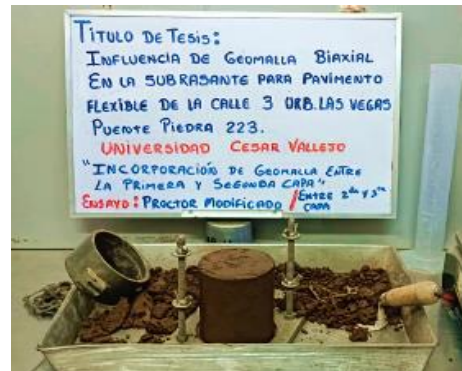
Foto 10: Incorporación de la geomalla en la 2 da capa del ensayo de Proctor modificado
