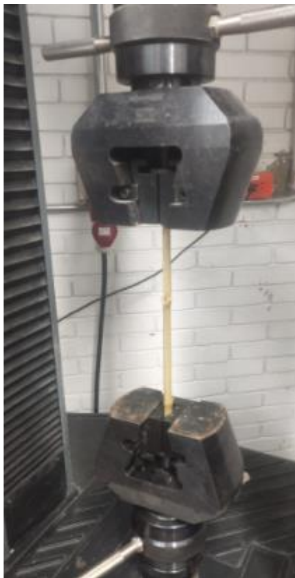
Figura N° 5: Ensayo de tensión en bambú. Fuente: Evaluación experimental de la superficie de barras de bambú como refuerzo para el concreto (Vergara & Vega, 2021)
