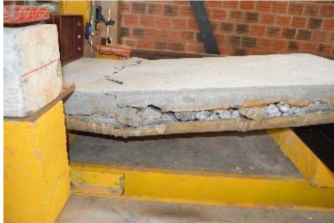
Figura N° 8: Rotura de losa de concreto armado. Fuente: Laje mista de bambu-concreto leve: Estudio teórico e experimental (Veloso & Doutor, 2017)
