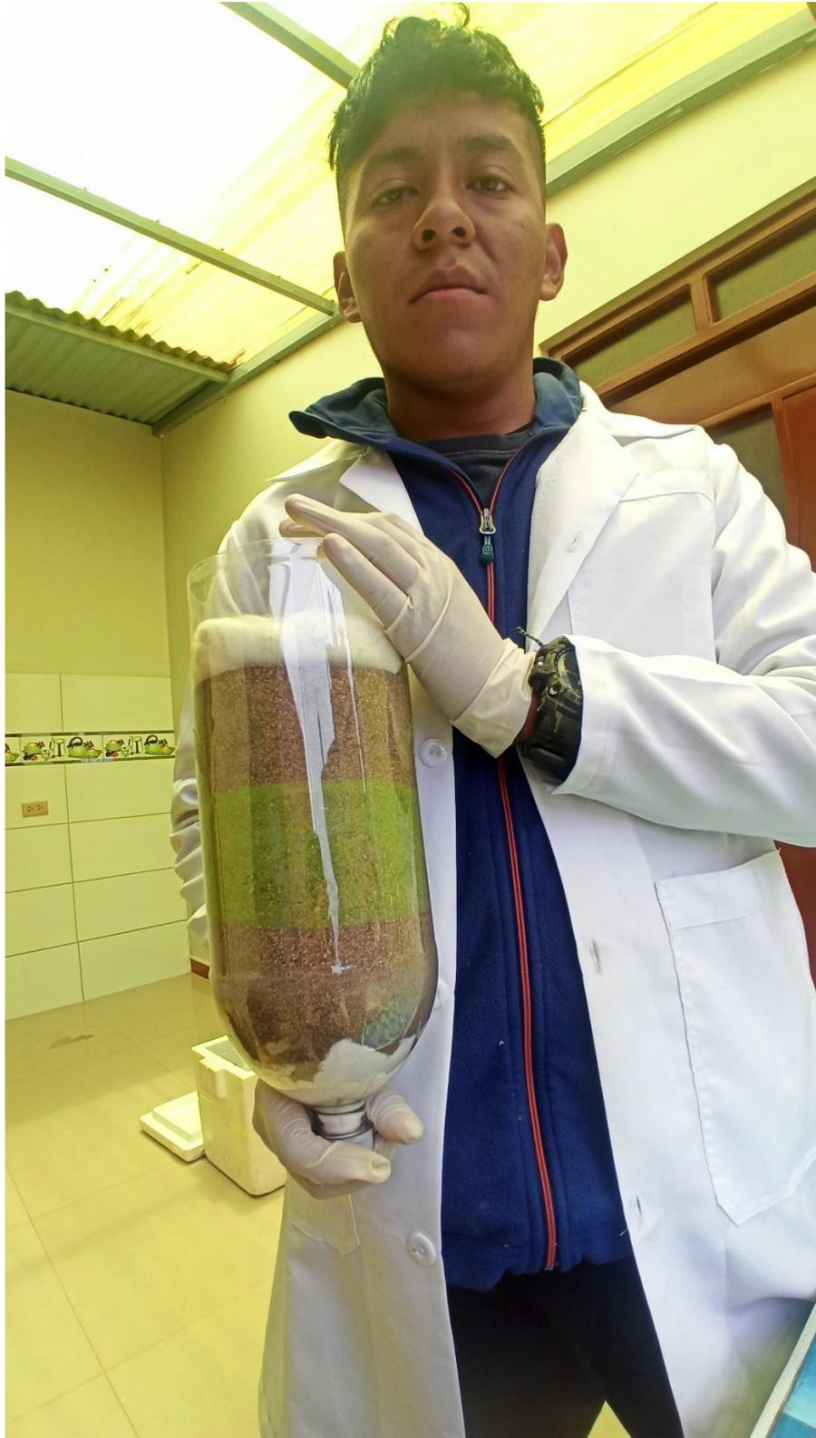
**Anexo 21.** A y B) Proceso de la elaboración del filtro de arena, y C y D) Instalación de los filtros para el tratamiento de las muestras de agua.
