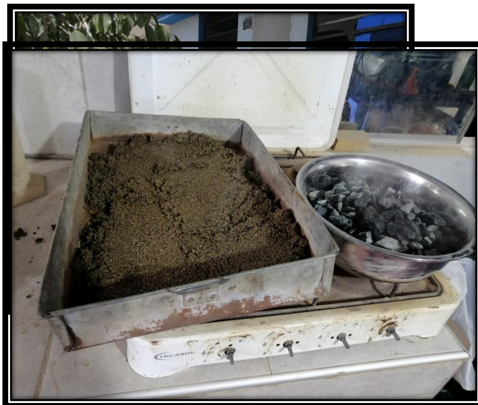
FOTO N° 11 - SECADO DE LAS MUESTRA DE AGREGADOS – ARENA Y PIEDRA
