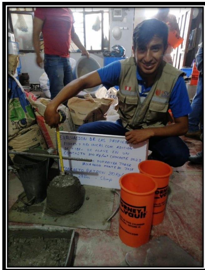
FOTO N° 17 LLENADO DE PROBETAS TANTO PARA COMPRESION, TRACCION Y FLEXION
