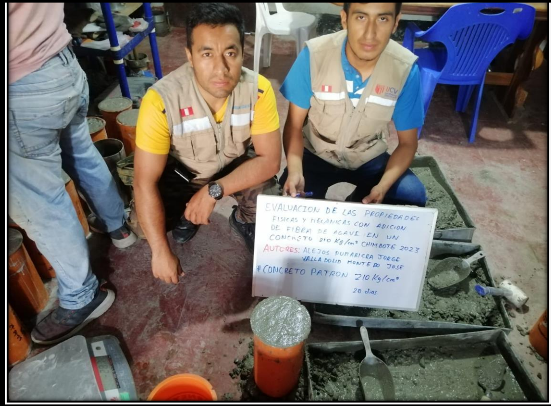
LLENADO DE PROBETAS DE FLEXION 7, 14 Y 28 DIAS
