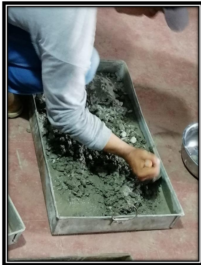
FOTO N° 16 ENSAYO DE SLUMP PARA PRUEBA PATRON 7, 14 Y 28 DIAS
