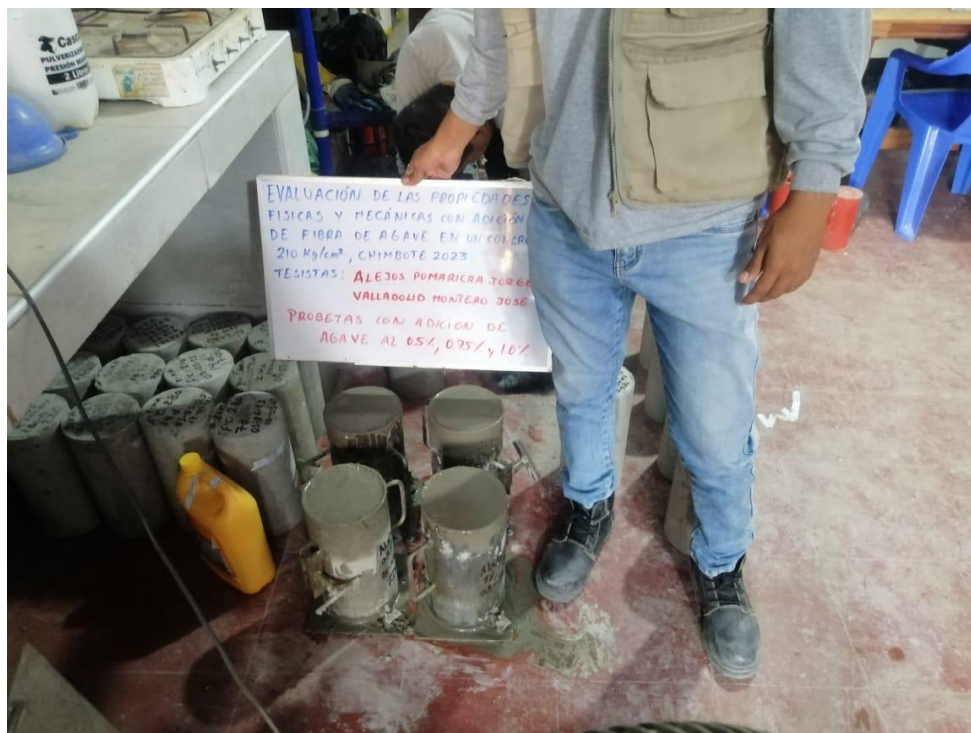
FOTO N° 23 LLENADO DE PROBETAS PARA COMPRESION Y TRACCION CON ADICION DE FIBRA DE AGAVE AL 0.5%, 0.75% Y 1.0%
