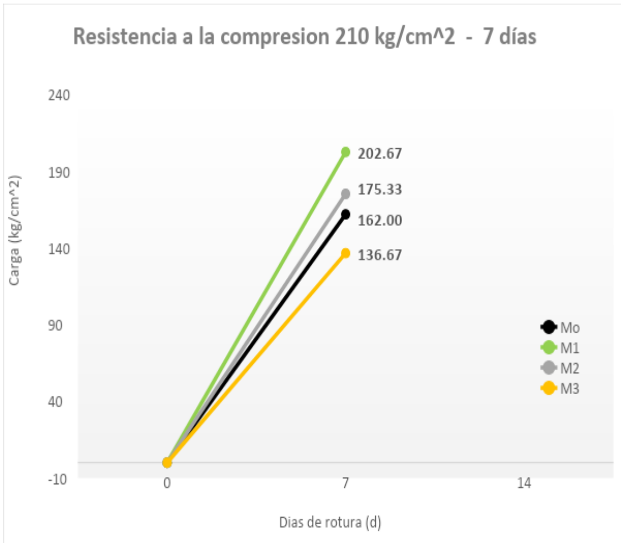
Figura 3. Gráfico de la prueba de compresión – 7 días
