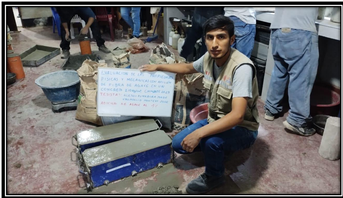
FOTO N ° 24 LLENADO DE MEZCLA PARA PROBETA EN ENSAYO A FLEXION CON ADICION DE FIBRA DE AGAVE AL 1%
