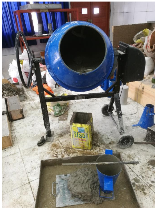
FOTO N°04: En la imagen se puede apreciar el Control de slump 6-7". con el cono de Abrams.
