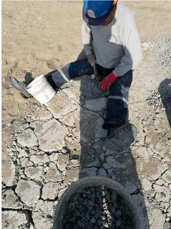
FOTO N°01: En la imagen se puede apreciar el triturado manual del al agregado de concreto reciclado de \frac{1}{2} ".
