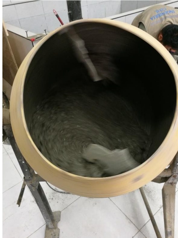
FOTO N°03: En la imagen se puede apreciar la preparación del concreto F'c=175\text{kg/cm}^2 en el laboratorio de la Universidad Cesar Vallejo.
