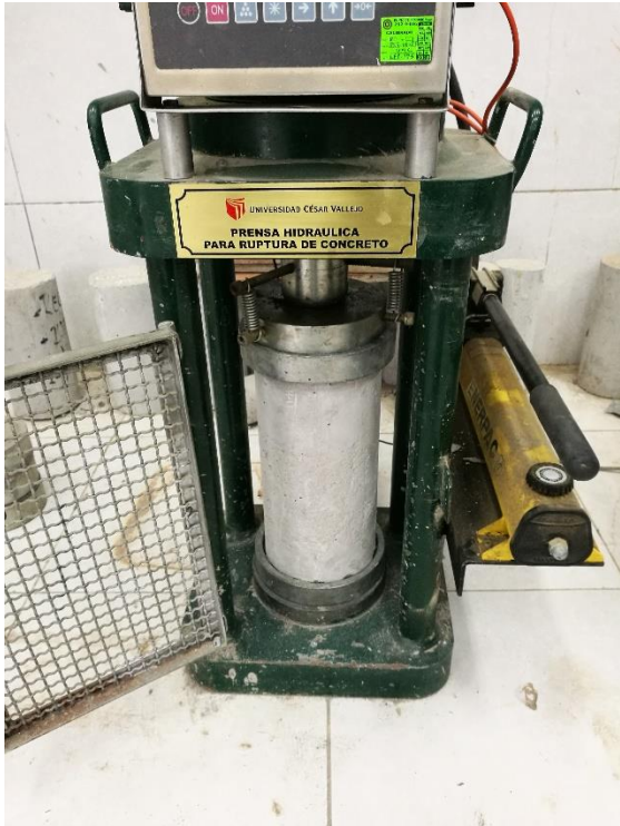
FOTO N°07: En la imagen se puede apreciar el ensayo mecánico a la compresión de las probetas cilíndricas.
