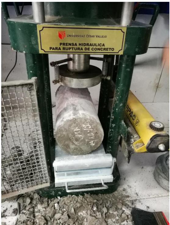
FOTO N°08: En la imagen se puede apreciar el ensayo mecánico a la tracción indirecta de las probetas cilíndricas.
