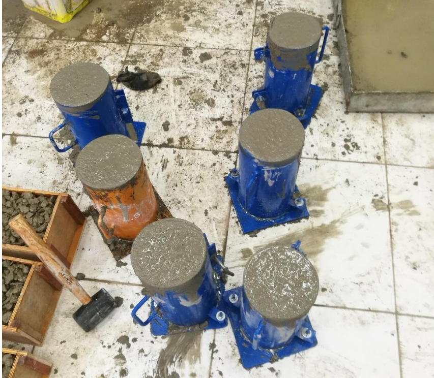
FOTO N°05: En la imagen se puede apreciar la Elaboración de probetas. cilíndricas F'c=175\text{kg/cm}^2 para ensayos mecánicos de compresión y tracción indirecta.
