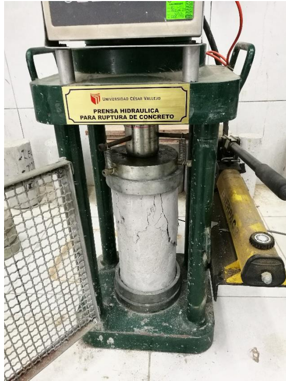
FOTO N°07: En la imagen se puede apreciar el ensayo mecánico a la compresión de las probetas cilíndricas.
