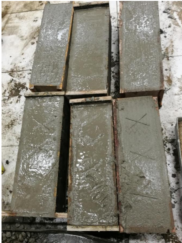
FOTO N°06: En la imagen se puede apreciar la elaboración de vigas de 0.50 \times 0.15 \times 0.15 F'c=175\text{kg/cm}^2 . para el ensayo mecánico a la flexión.
