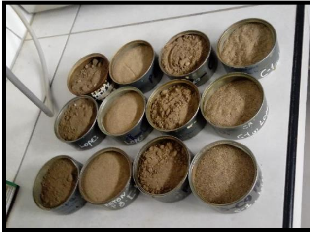
Figura 10: Ensayo para hallar el porcentaje de humedad, laboratorio de la UCV.
