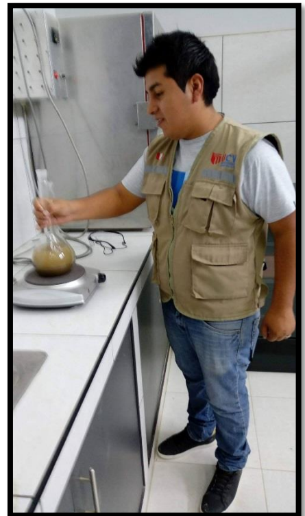
Figura 11: Ensayo con Picnómetros para hallar el Peso específico, laboratorio de la UCV.
