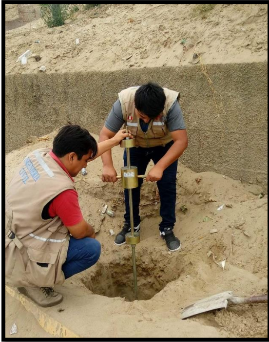
Figura 6: Ensayo de DPL, resultados del laboratorio de la UCV
