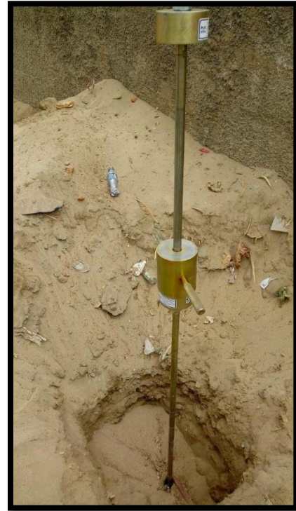
Figura 6: Ensayo de DPL, resultados del laboratorio de la UCV
