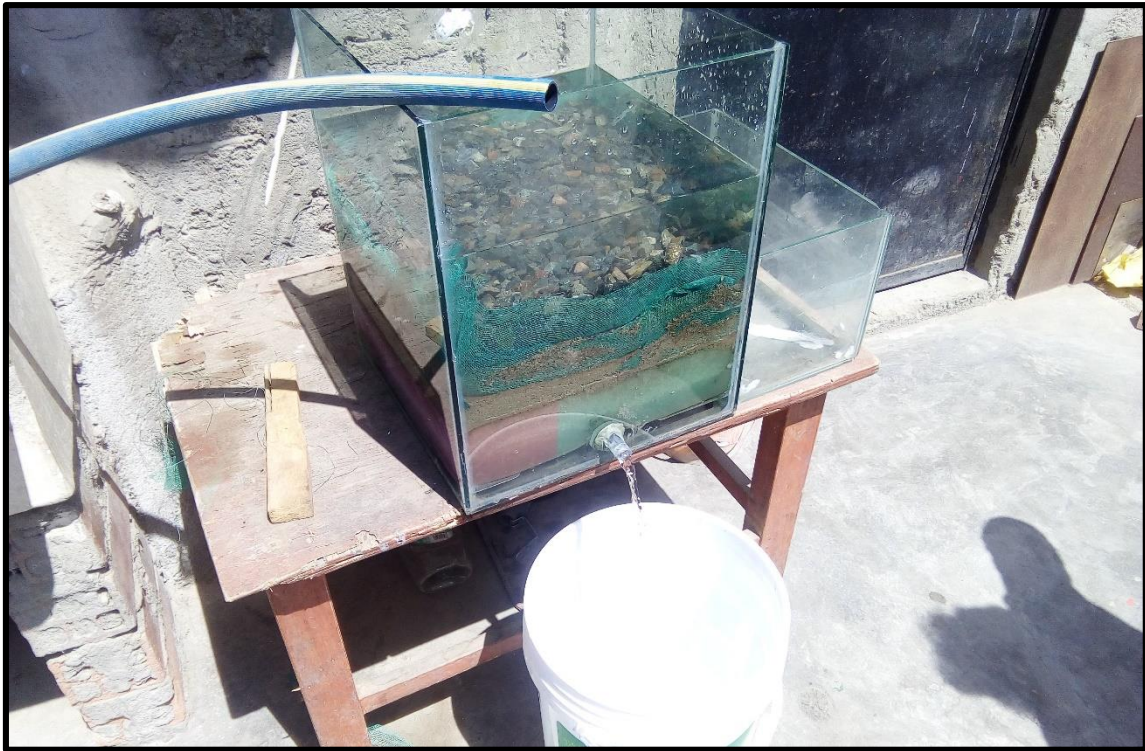
FOTO N° 03.- Vista del filtro de gravas donde se encuentra filtrando las aguas grises.
