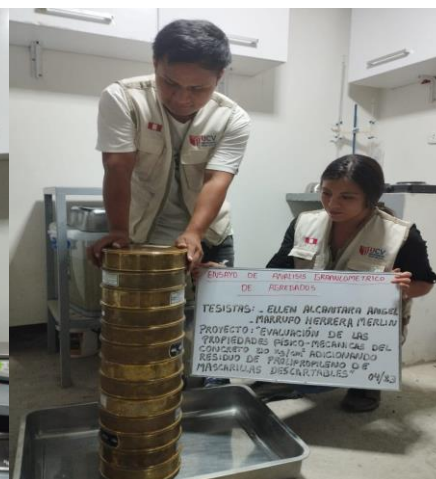
FOTOGRAFIA 2 | Ensayo para contenido de humedad y vacío de agregados; ensayo granulométrico.
