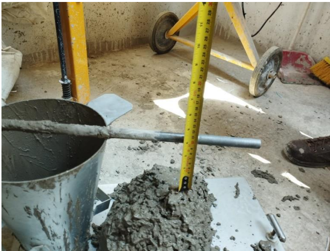
FOTOGRAFIA 4 Ensayo de cono de Abrams.
