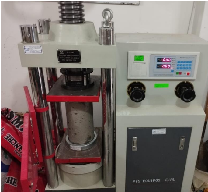
FOTOGRAFIA 8 | Ensayo resistencia a compresión.
