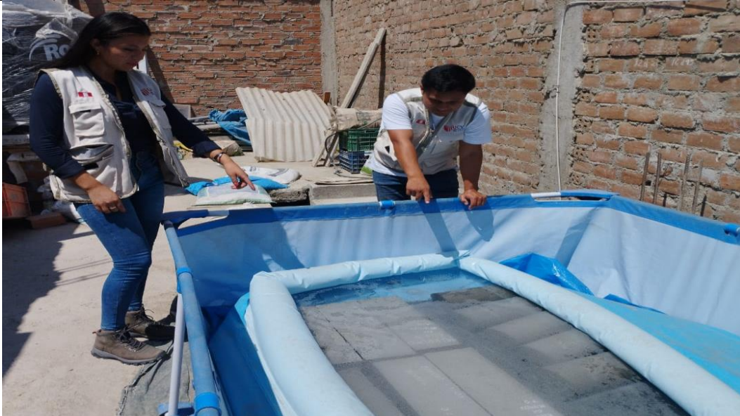
FOTOGRAFIA 7 | Curado de probetas y vigas.
