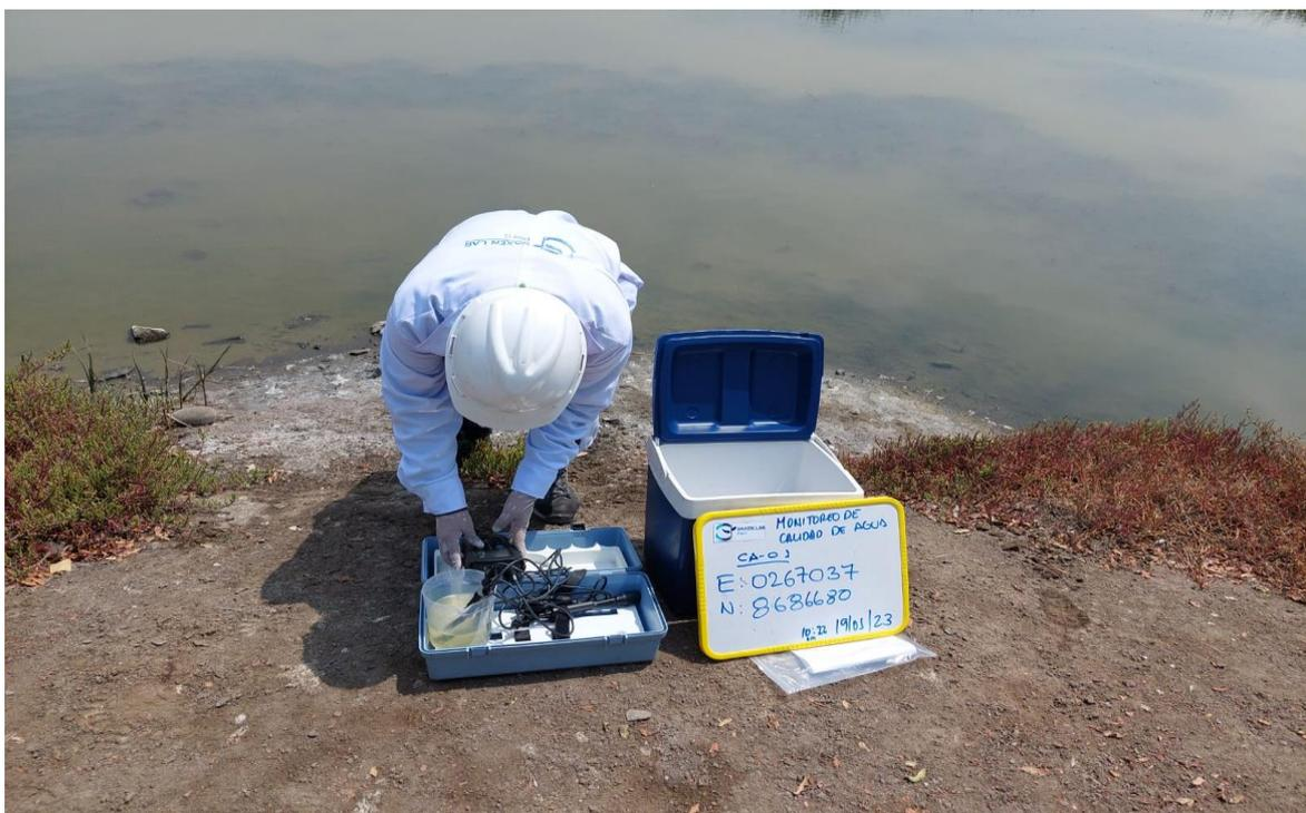
Anexo 6: Medición de conductividad eléctrica y pH con multiparámetro
