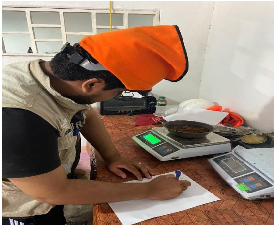
Pesado de material extraído de calicata.
