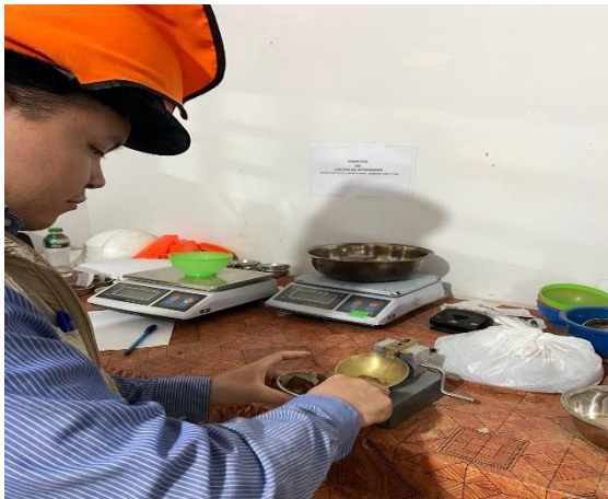
Muestra ensayo de límite líquido, dando los 25 golpes a la copa de casa grande.
