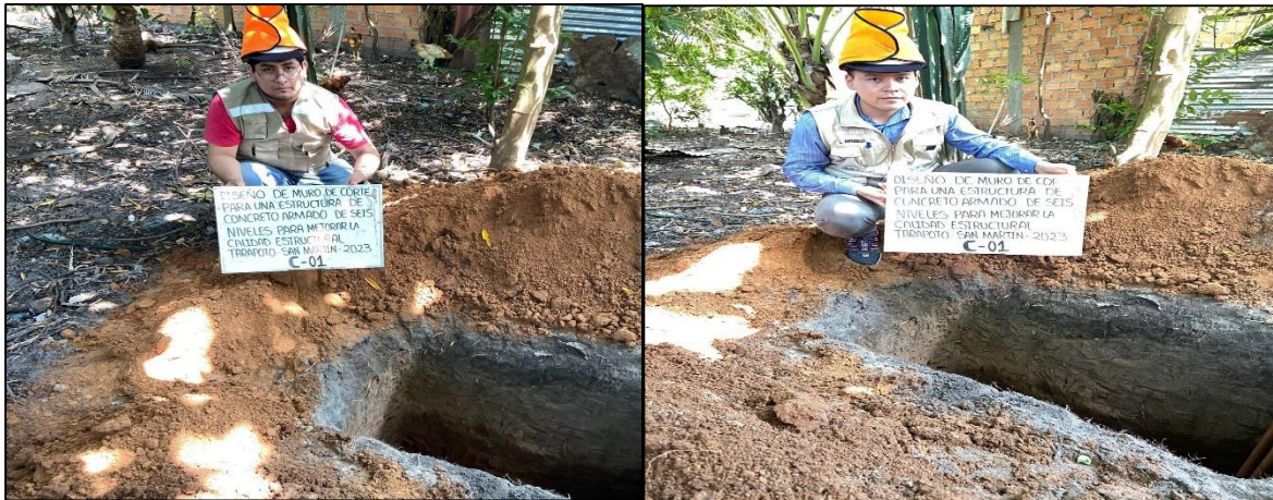
Excavación de calicata, con medidas 1.00 x 1.00 de ancho y 3m de altura.
