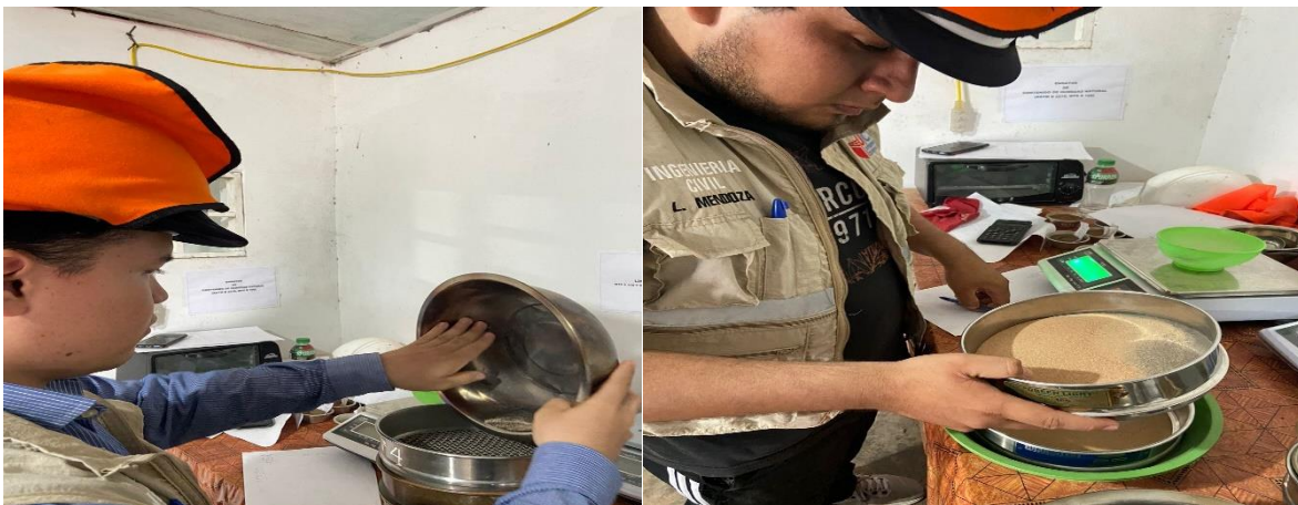
Ensayo de análisis granulométrico, distribución de partículas, que pasen la malla N°200, agitando las muestras mediante tamices.
