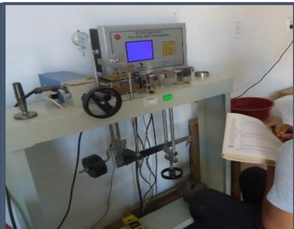
Muestra ensayo de corte directo para obtener los esfuerzos de corte.
