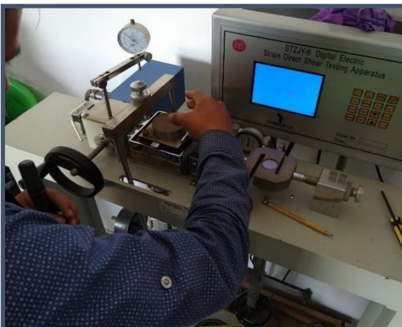
Muestra ensayo de corte directo para obtener los esfuerzos de corte.
