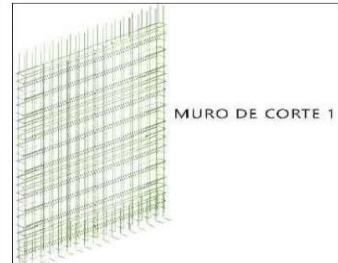
MURO DE CORTE ASCENSOR
