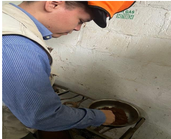
Secado de material extraído de calicata, para el ensayo de contenido de humedad.
