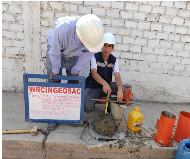
Figura 41. Prueba del asentamiento en el concreto de referencia o estándar con la incorporación de un aditivo
