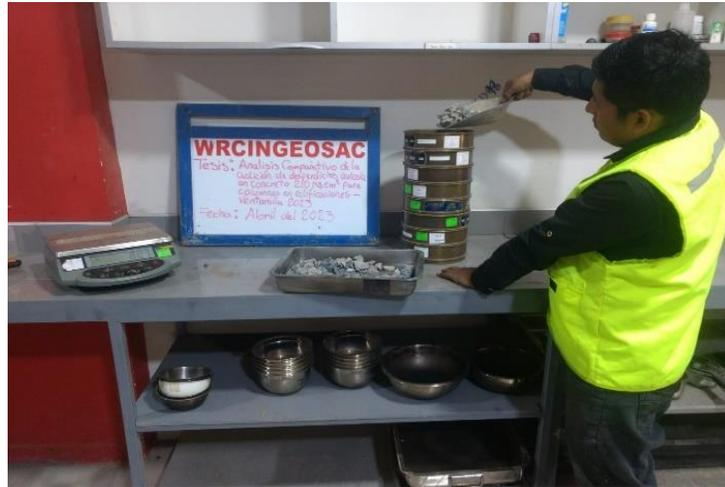
Figura 29. Método de clasificación del agregado grueso mediante el tamizado.
