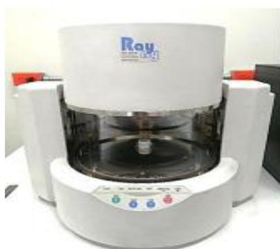
Figura 19. Análisis de composición química usando el espectrómetro de fluorescencia de rayos X de energía dispersa (SHIMADZU, EDX-800HS)
