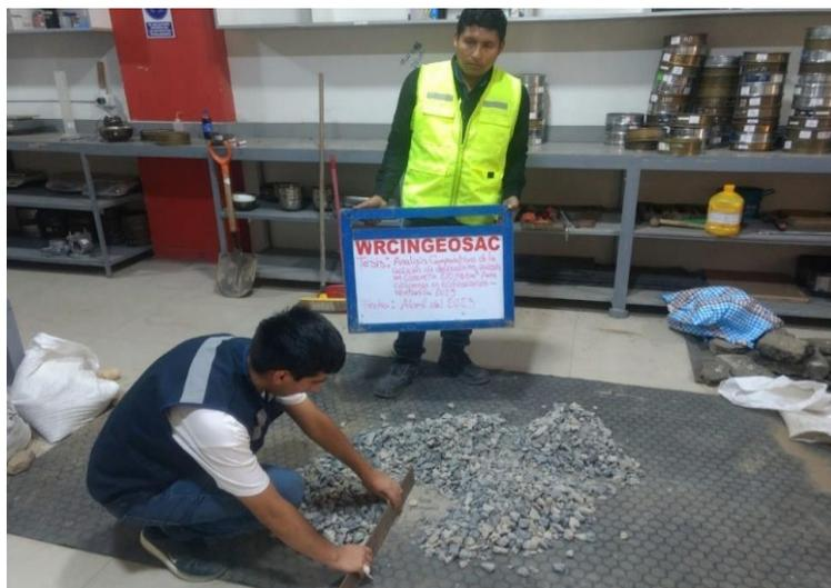
Figura 21. Procedimiento de fraccionar el AG.
