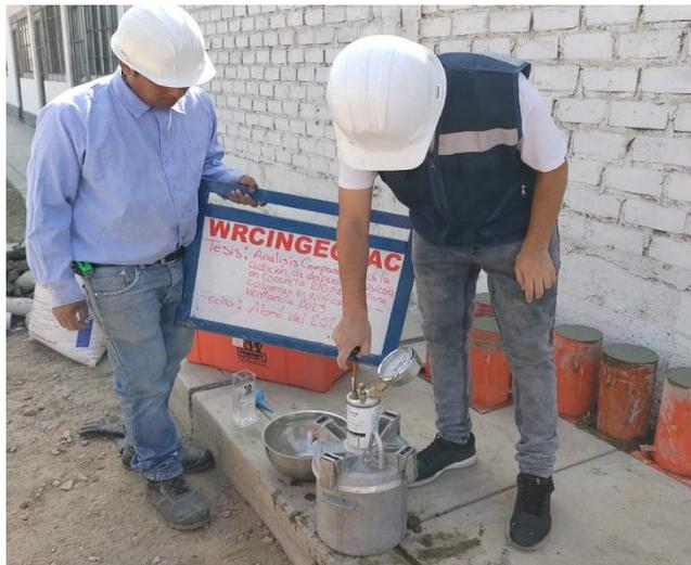
*Figura 37. Prueba del contenido de aire en el concreto que contiene ceniza proveniente de desperdicios avícolas*
