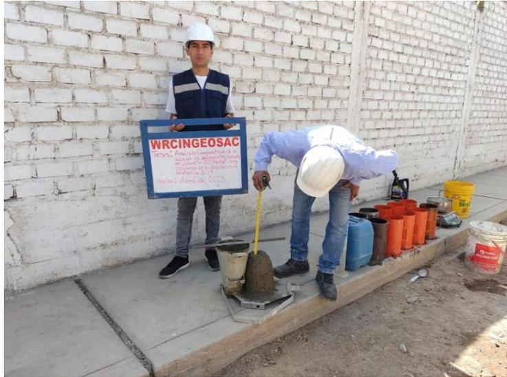
Figura 40. Prueba del asentamiento en el concreto de referencia o estándar
