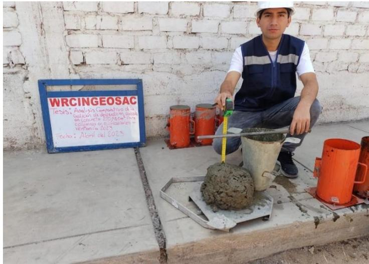
Figura 42. Prueba del asentamiento en el concreto que contiene ceniza proveniente de desperdicios avícolas.
