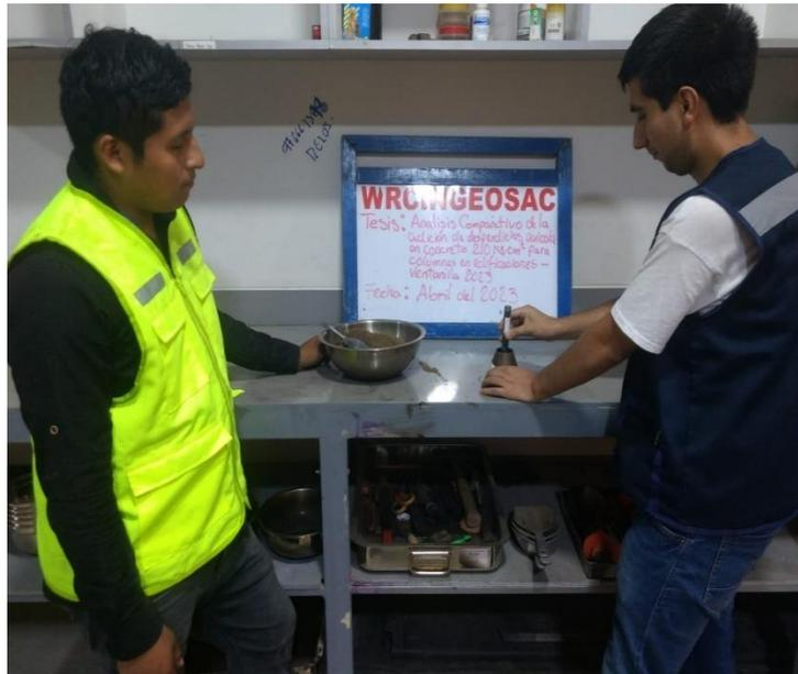
Figura 26. Prueba de la densidad del agregado fino bajo compactación
