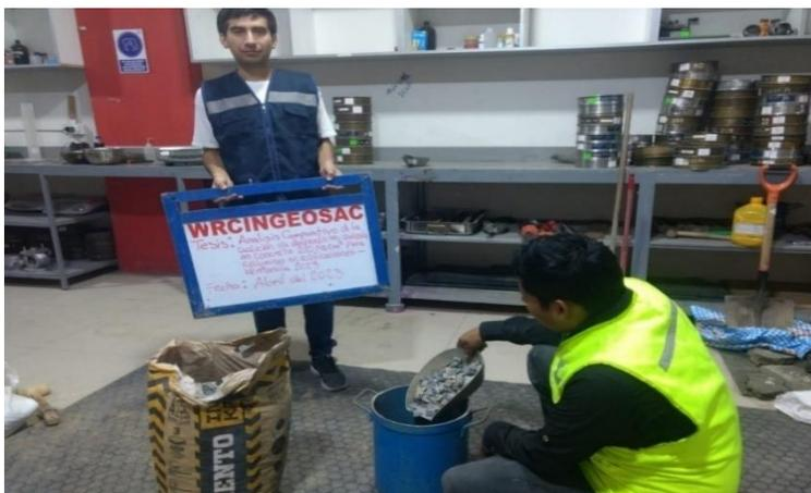
Figura 24. Prueba de la densidad seca del agregado grueso.
