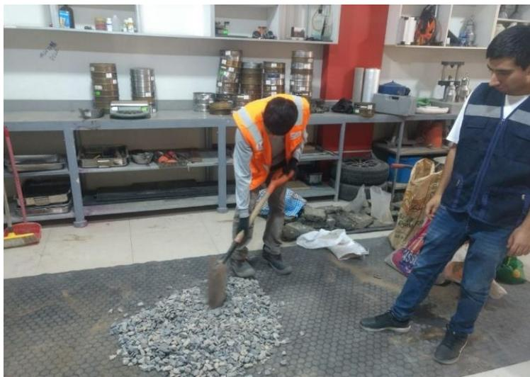
Figura 20. Proceso de obtener la muestra de AG
