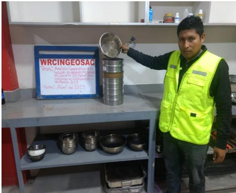
Figura 31. Método de clasificación del agregado fino mediante el tamizado.
