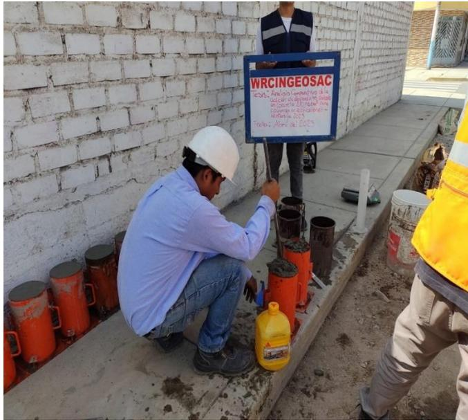
Figura 44. Colocación de muestras de concreto de referencia o estándar con la incorporación de un aditivo en probetas
