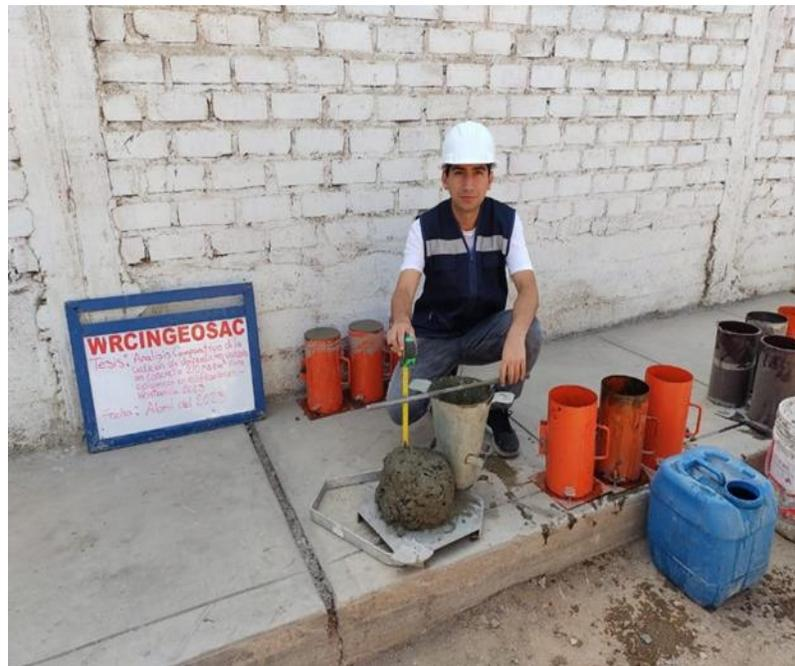
**ROTURA DE PROBETAS**
