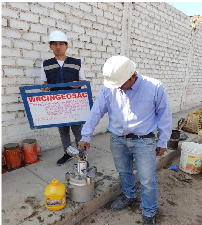
*Figura 39. Prueba del contenido de aire en el concreto de referencia o estándar con la adición de un aditivo*
