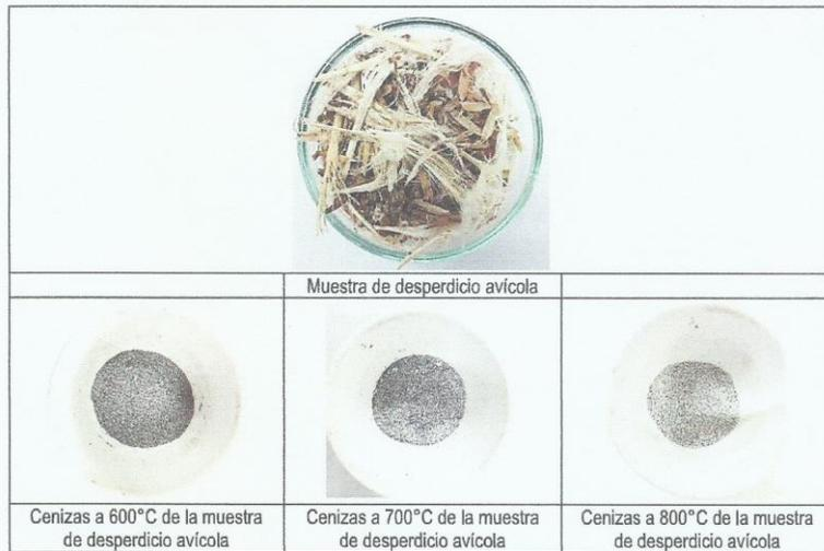
FIGURA N°1. MUESTRA DE DESPERDICIOS AVÍCOLAS Y SUS CENIZAS.
