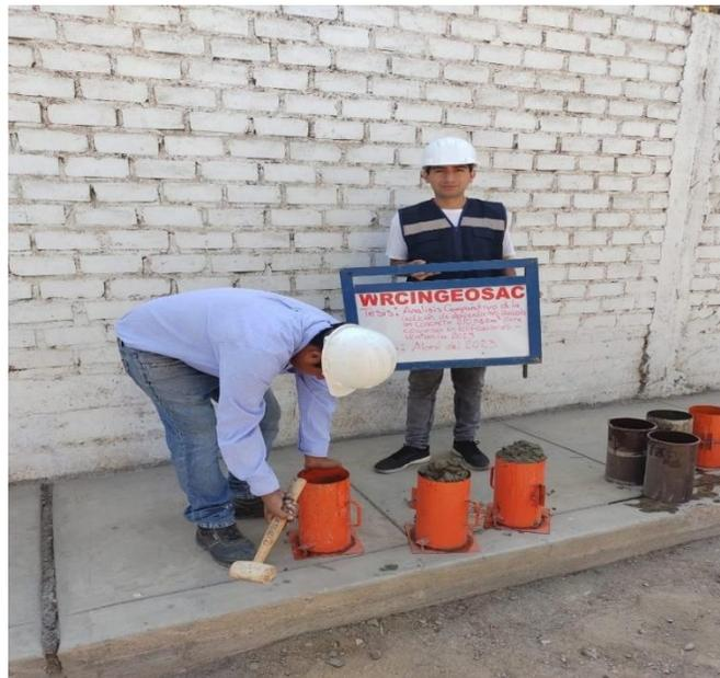
Figura 43. Colocación de muestras de concreto de referencia o estándar en probeta
