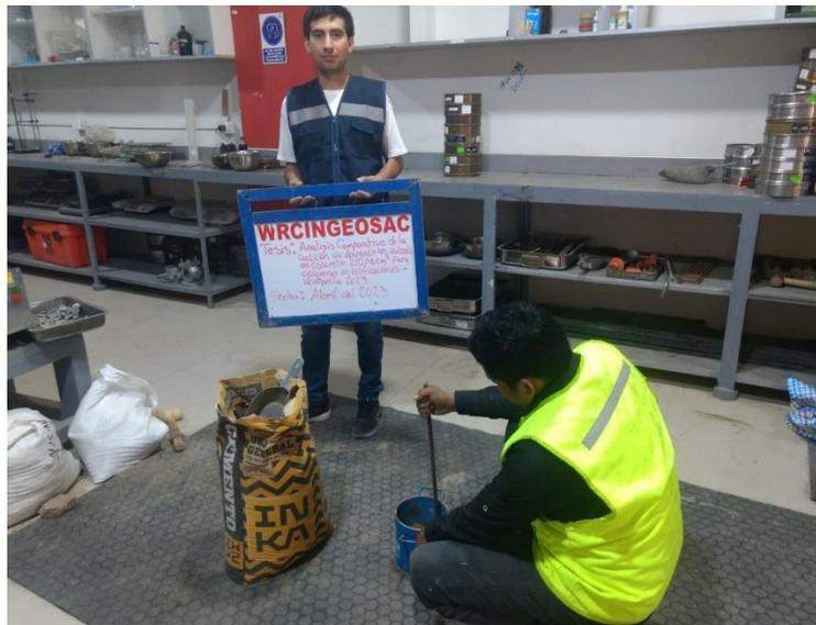
Figura 27. Prueba de la densidad del agregado grueso bajo compactación
