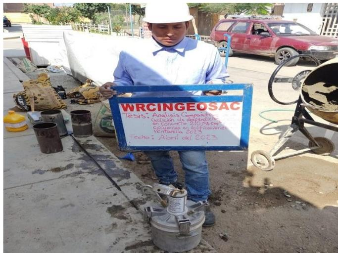
*Figura 38. Prueba del contenido de aire en el concreto de referencia o estándar*
