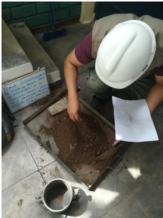
Foto 20. Incorporación de fibras de plástico al suelo de estudio.
