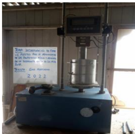
Foto 28. Ensayo de CBR
