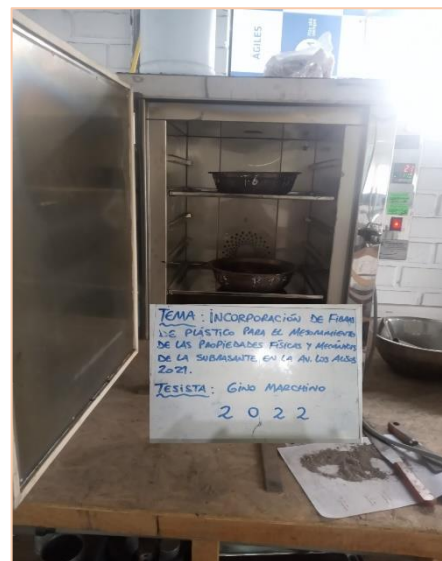
Figura 10. Colocación de la muestra para el secado
