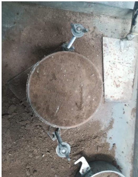
Foto 22. Muestra compactada a 25 golpes con fibras de plástico PET.
