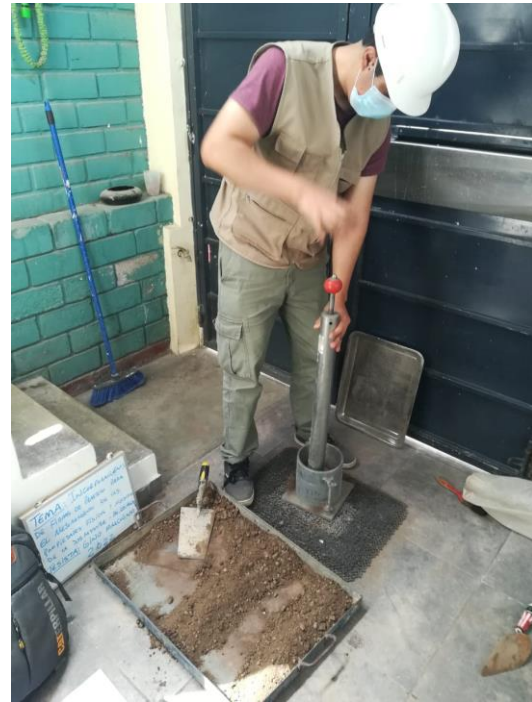
Foto 21. Compactación de la muestra con las fibras de plástico PET.
