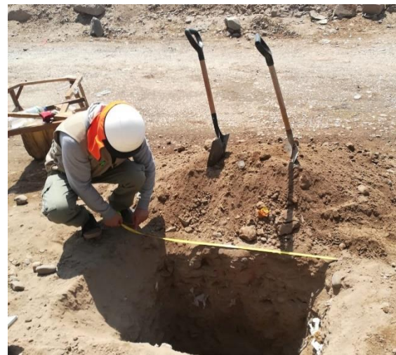
Foto 8. Toma de medida del largo a 1.30 m para la calicata C2
