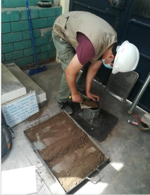
Figura 11. Colocación de la muestra para la compactación.
