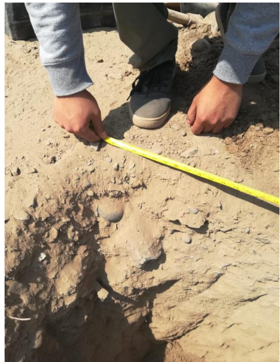
Foto 12. Toma de medida del ancho a 0.50 m para la calicata C3
