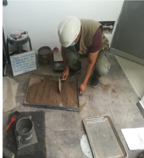
Foto 14. Mezclado de la muestra C1
