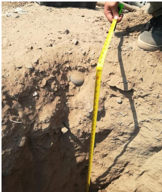
Foto 3. Toma de medida de la profundidad a 1.50 m para la calicata C1
