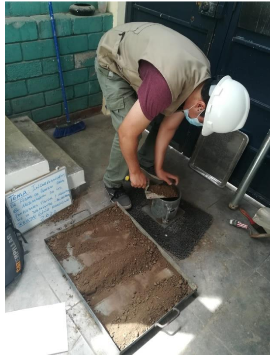
Foto 18. Empleo del molde con la muestra C1 para el ensayo de CBR
