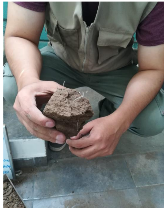
Foto 22. Porción de muestra compactada con fibras de plástico PET.
