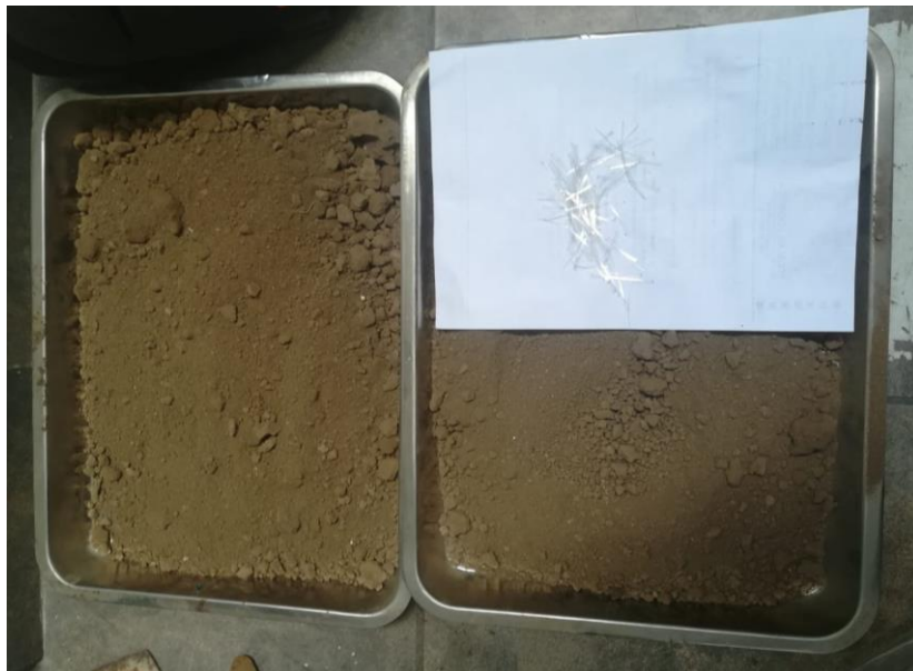
Foto 19. Muestra C1 y fibras de plástico PET con ancho de 0.90 mm y longitud de 48 a 55 mm.
