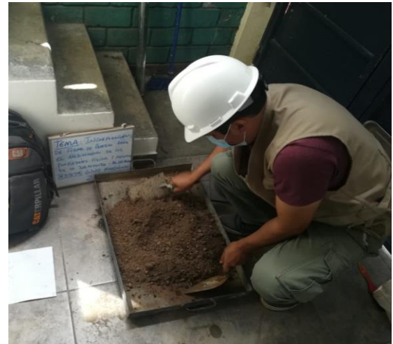
Foto 16. Mezclado de la muestra C1 para el ensayo de Atterberg
