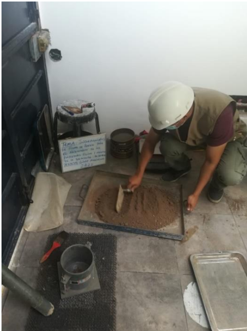
Figura 15. Cuarteo de la muestra para el análisis granulométrico
