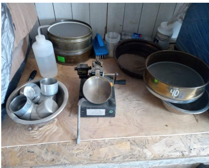
Figura 9. Materiales para el ensayo de límite de Atterberg.
