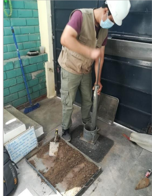
Figura 12. Compactación del suelo mediante el martillo manual
