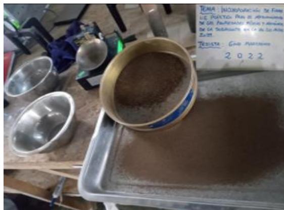
Foto 25. Selección de muestra para el ensayo de límites
