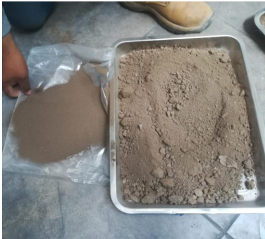
Foto 15. Material de la muestra C1 pasante por la malla n° 40 para límites de consistencia
