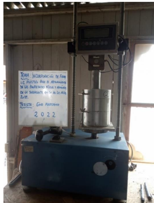
Figura 16. Análisis de la muestra del suelo con prensa CBR.
