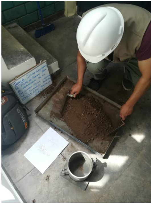
Foto 17. Mezclado de la muestra C1 para el ensayo de CBR
