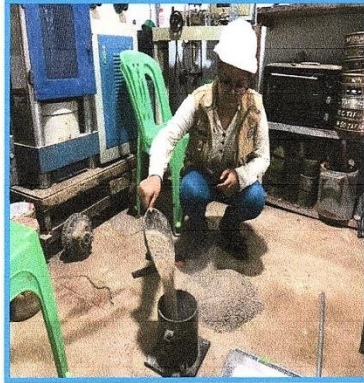
PESO UNITARIO SUELTO DEL AGREGADO FINO
