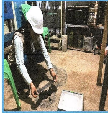
PESO UNITARIO SUELTO DEL AGREGADO FINO
