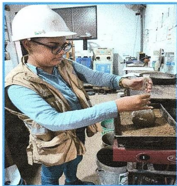
GRAVEDAD ESPECIFICA Y ABSORCION
