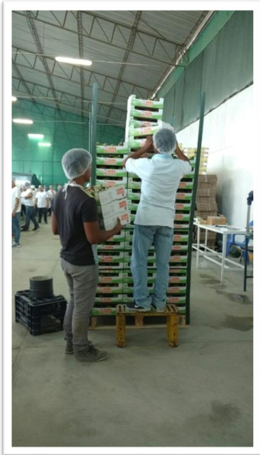
Foto 8.4.5 Llenado de la parte superior del pallet.
