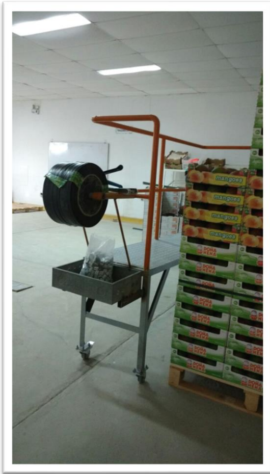
Foto 8.5.1 Dispensador de zuncho, caja porta grapas, enzunchadora y cortadora.
