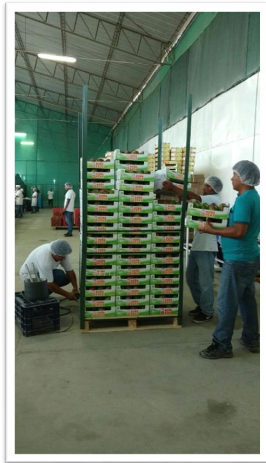
Foto 8.4.4 Enzunchado de la parte inferior.
