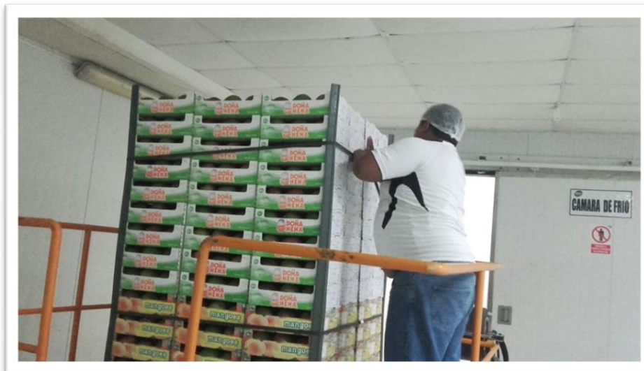
Foto 8.5.8 Enzunchado del pallet montado sobre el andamio.
