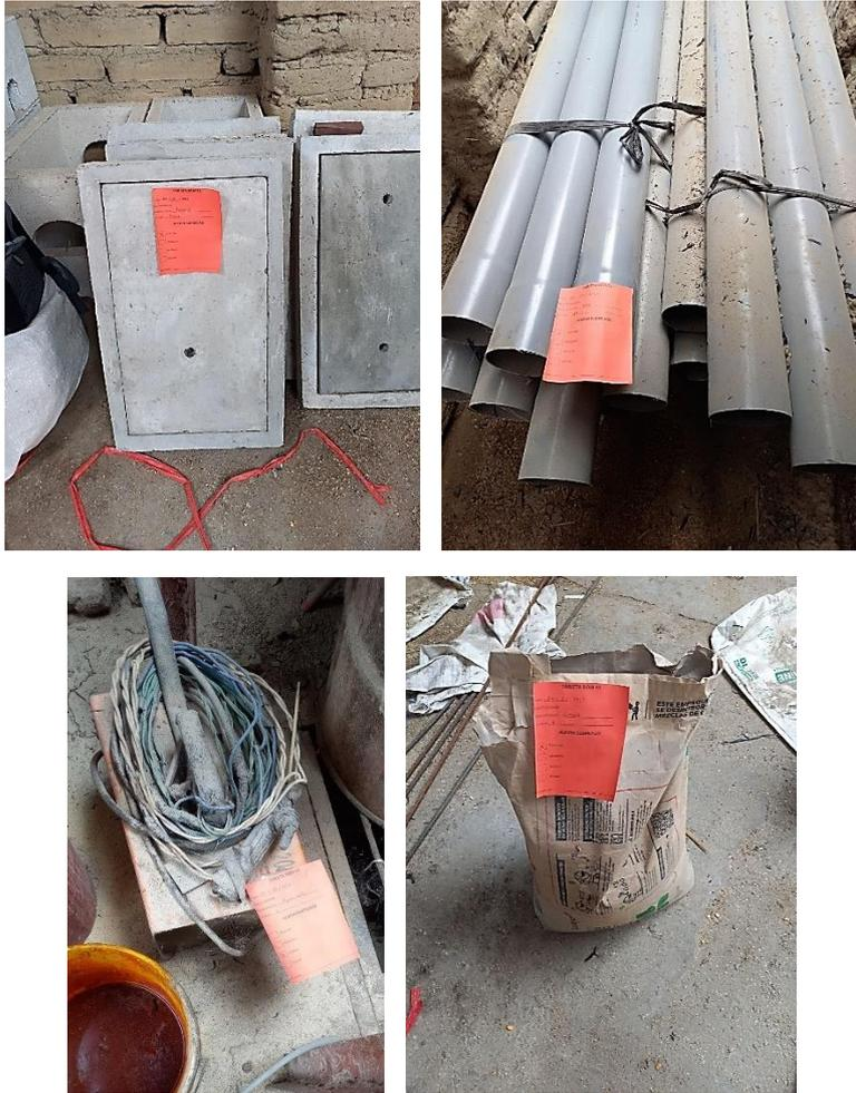
**Figura 17:** *Uso de las tarjetas rojas en el área de producción del molino Synutre*
