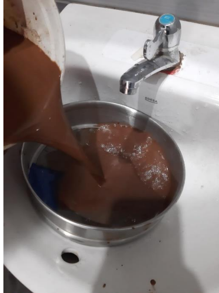
Figura 28: Lavado de la muestra arcillosa tamiz N°200 (fuente propia).
