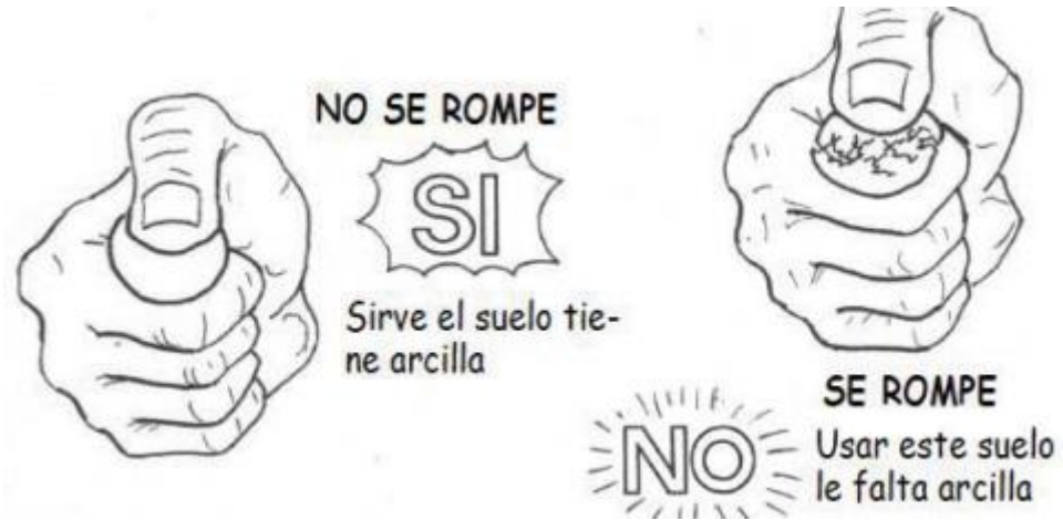
Figura 26: Ensayo de presencia de arcilla (Fuente: Norma E. 080).
