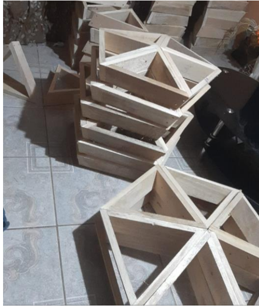
Figura 18: Ensamblado de piezas del domo (fuente propia).
