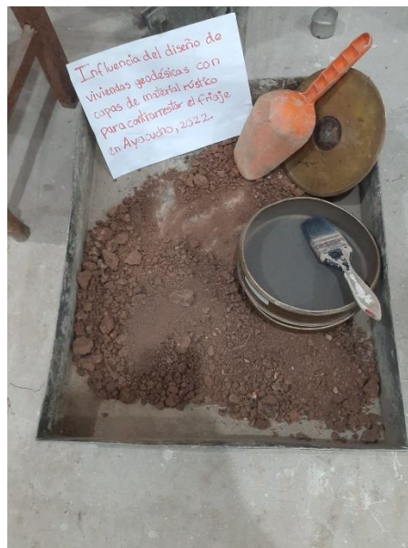
Figura 27: Separación de la muestra por la malla N° 40 (fuente propia).
