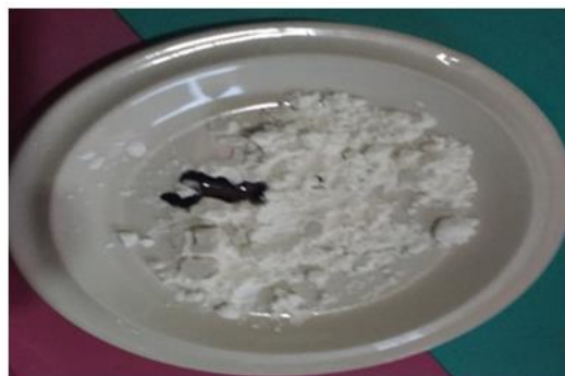
Presencia del color azul oscuro como prueba de la presencia de almidón
