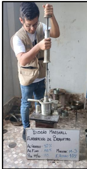
Imagen N° 9: Compactación de mezcla asfáltica convencional
