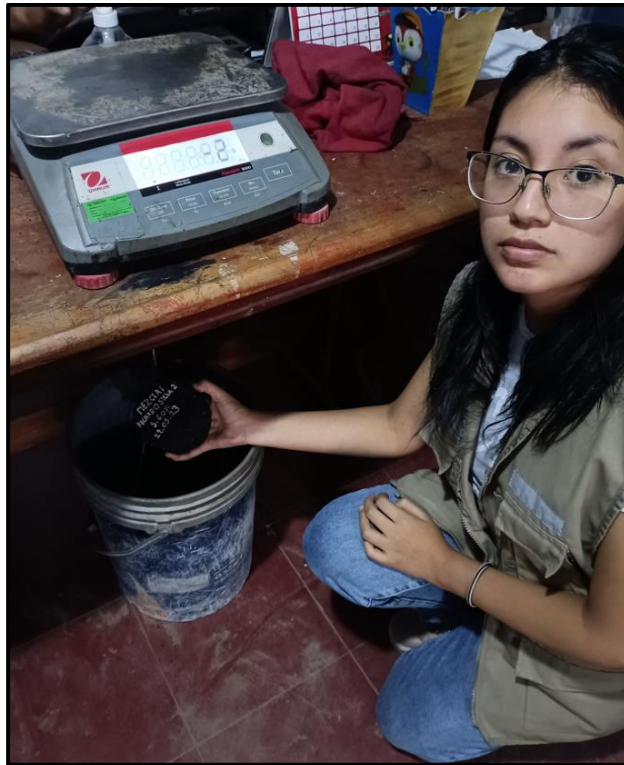
Determinación del peso sumergido de cada briqueta modificada con 1%, 5% y 10% de fibra de acero
