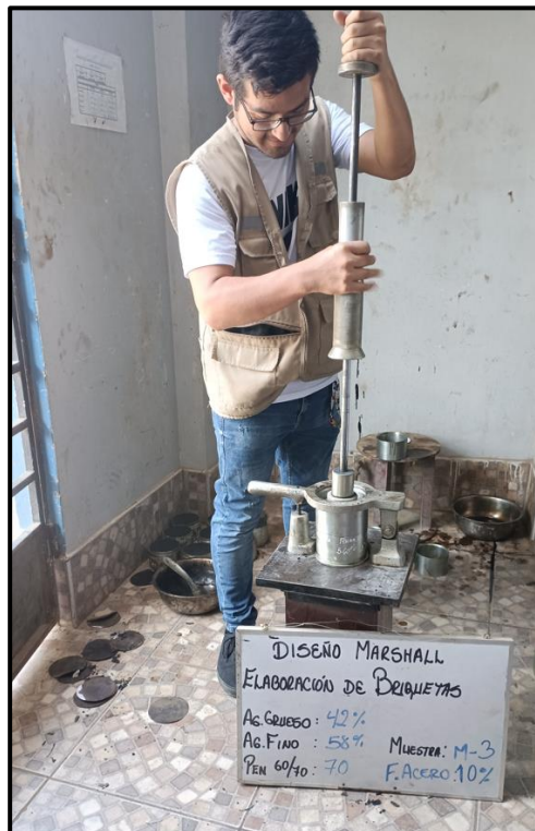
Compactación de mezcla asfáltica modificada con 10% de fibra de acero
