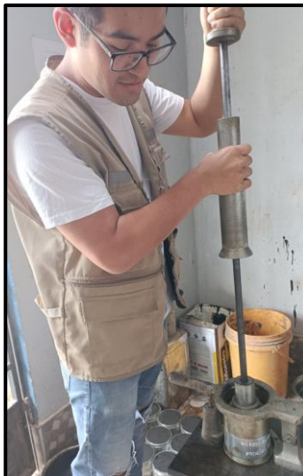
Imagen N° 5: Compactación de mezcla asfáltica convencional
