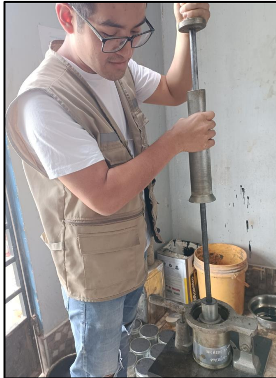
Se realiza el compactado para la elaboración de la briqueta
