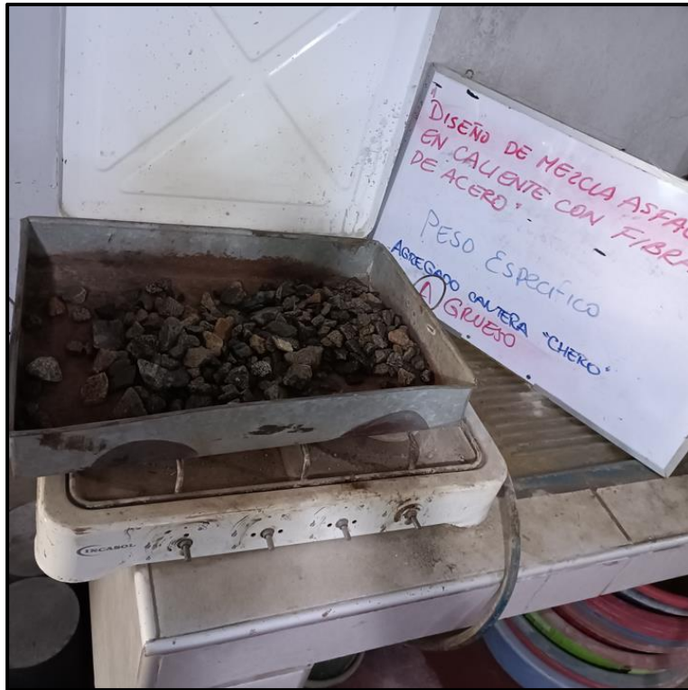
Imagen N° 13: Secado del agregado grueso en cocina
