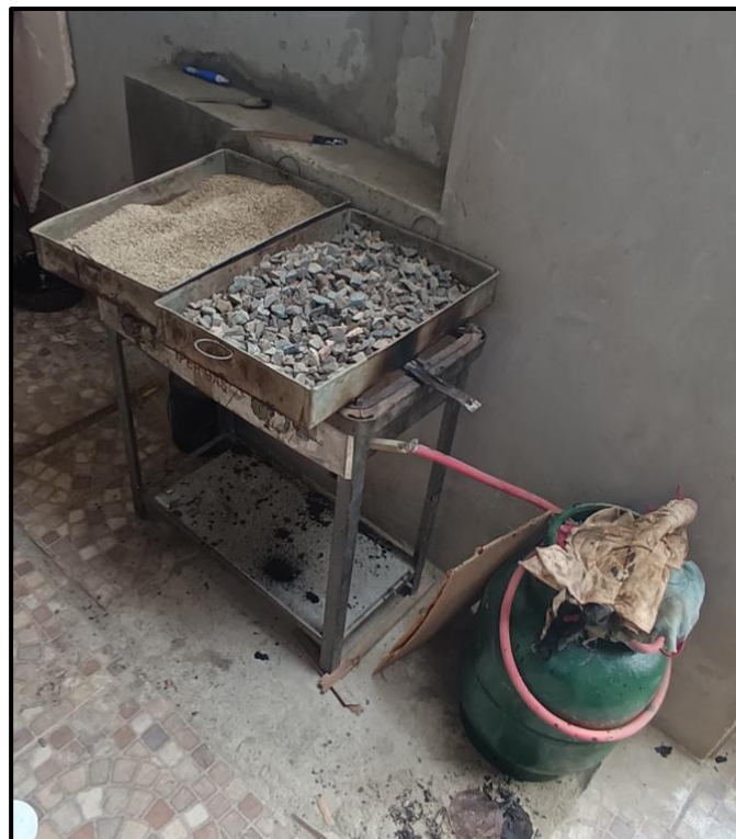
Imagen N° 18: Calentamiento del agregado fino y grueso
