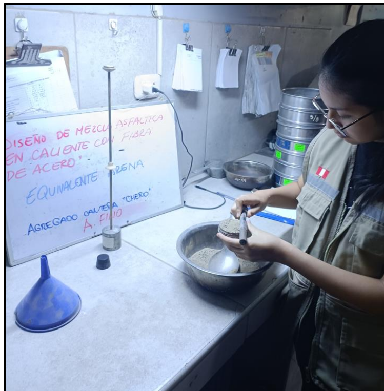
Llenado de molde con arena para ensayo equivalente arena
