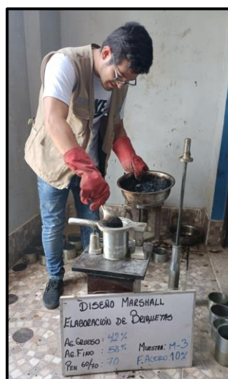
Imagen N° 8: Llenado de mezcla asfáltica convencional
