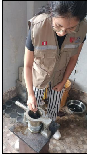
Imagen N° 4: Llenado de mezcla asfáltica convencional
