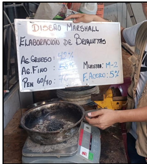
Imagen N° 7: Mezcla asfáltica convencional
