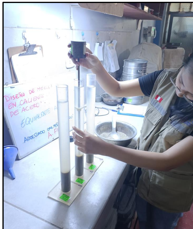
Imagen N° 8: Medición de la cantidad de arena y finos
