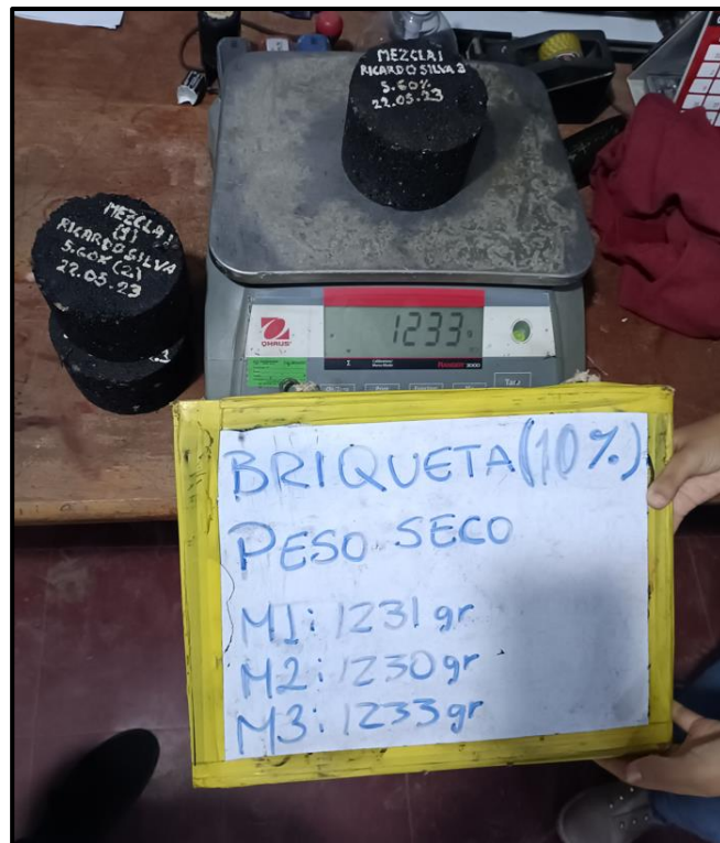
Determinación del peso de cada briqueta modificada con 1%, 5% y 10% de fibra de acero
