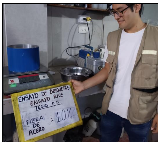
Imagen N° 12: Peso del contenedor más mezcla modificada
