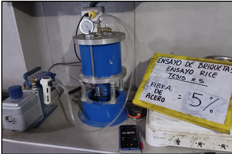
Ensayo rice para determinación de porcentajes de vacíos de la mezcla asfáltica modificada con 5% de fibra de acero
