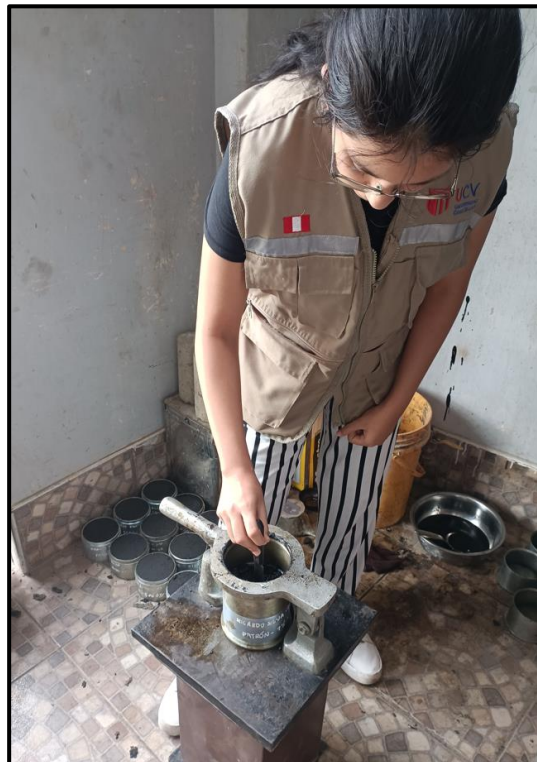
Llenado de mezcla asfáltica y chuceado
