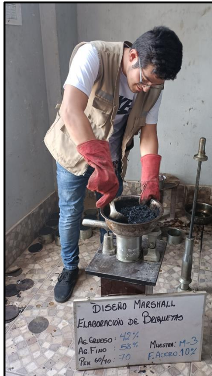
Llenado de molde con mezcla asfáltica modificada con 10% de fibra de acero
