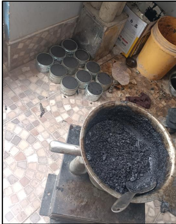
Se observa la mezcla ya homogenizada lista para el llenado
