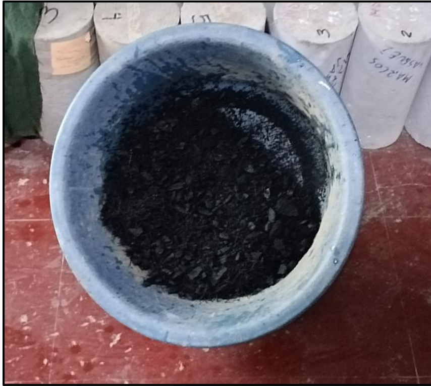
Material restante luego del ensayo Rice
