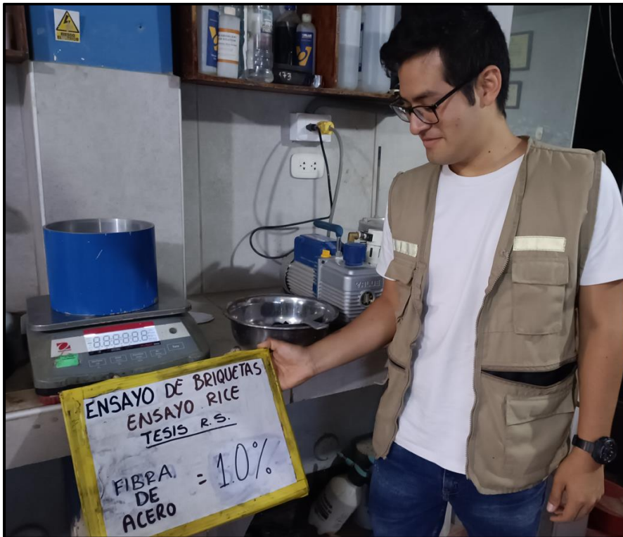
Ensayo rice para determinación de porcentajes de vacíos de la mezcla asfáltica modificada con 10% de fibra de acero
