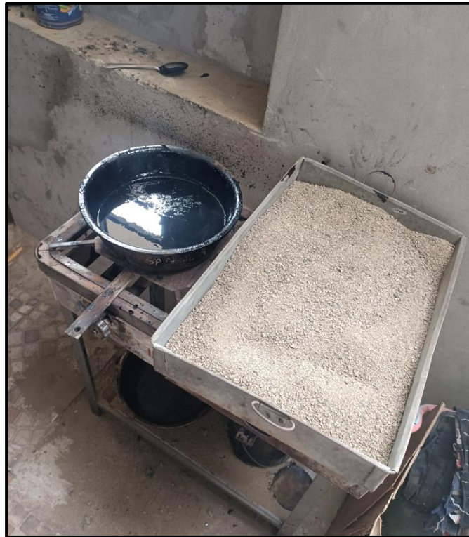
Los agregados se calientan a una T° de 130°C
