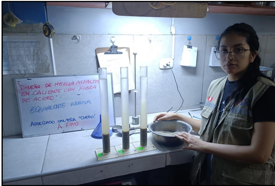
Imagen N° 7: Llenado de los tubos con el agregado fino y agua
