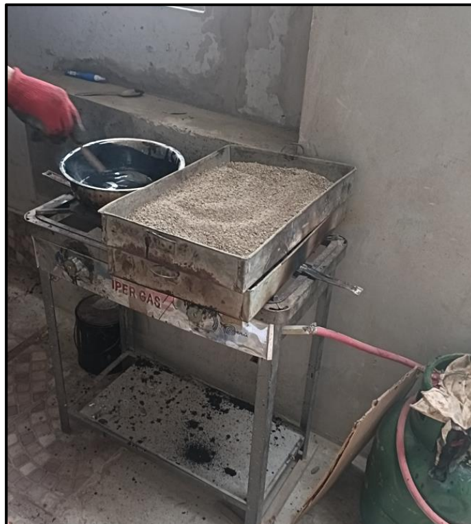
Se calienta el asfalto a una T^{\circ} de 130^{\circ}\text{C}
