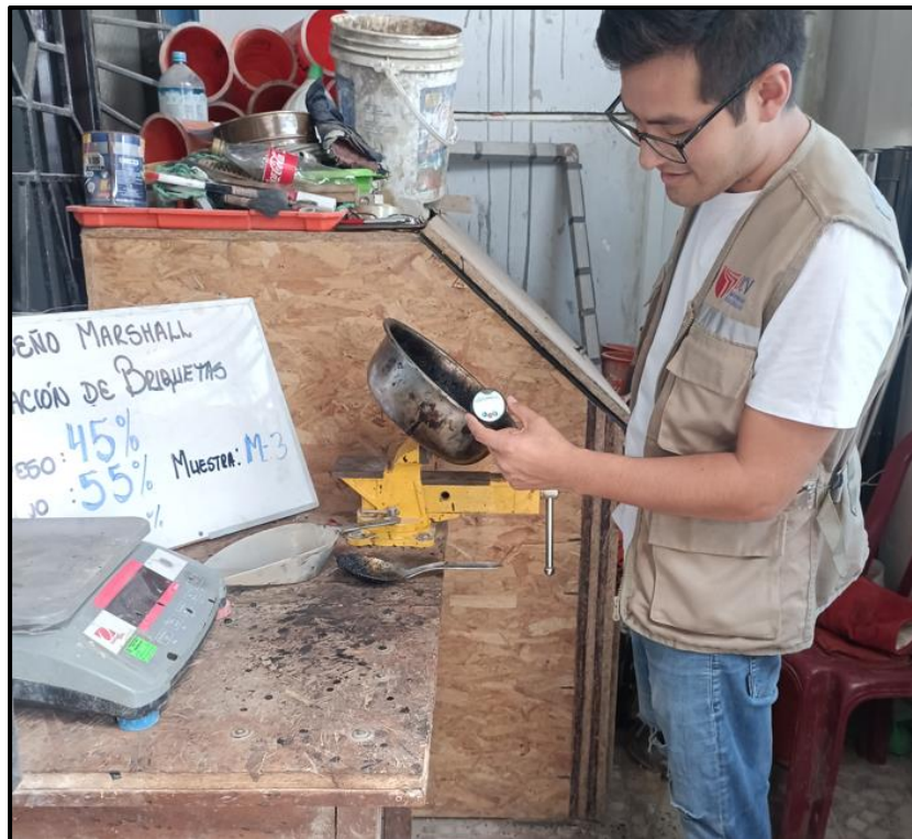
Se controla la T^{\circ} que no sobrepase rápidamente los 130^{\circ}\text{C}
