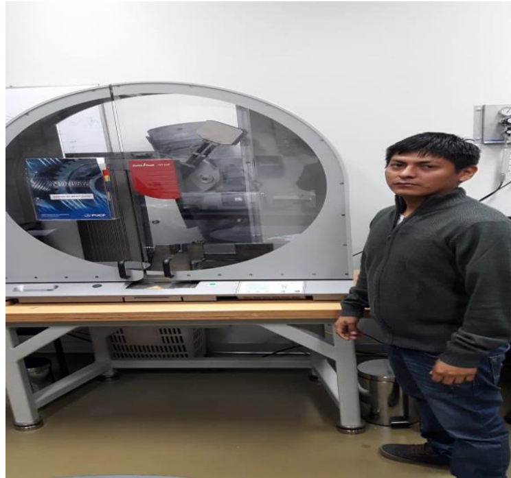
Fotografía : Se puede observar las probetas sometidas al ensayo de impacto norma ASTM D256-1 de la maquina Zwick/Roell
