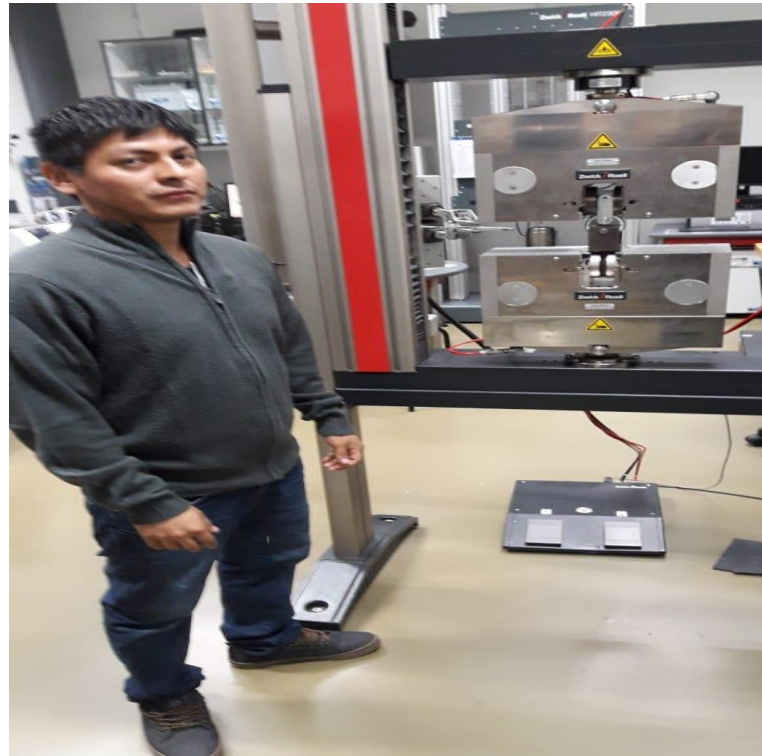
Fotografía: Se puede observar las probetas sometidas al ensayo de tracción anular norma ASTM D2290-12 de la maquina Zwick/Roell 2050
