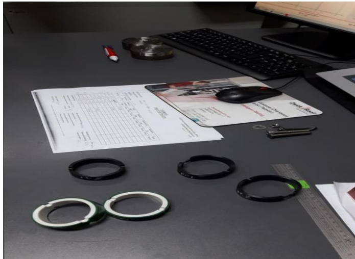
Fotografía: Se puede observar las probetas utilizada para el ensayo de tracción
