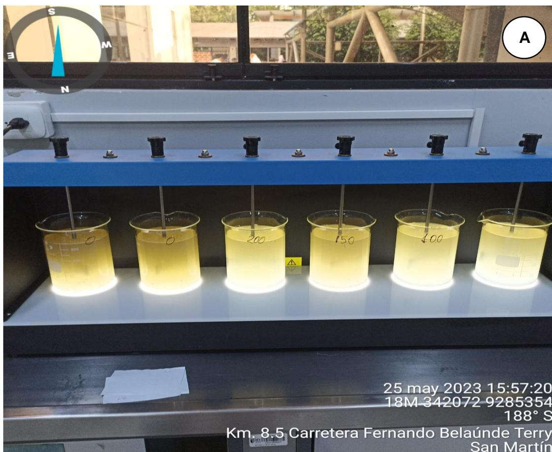
Nota: (A), se muestra la efectividad del coagulante de *moringa Oleifera*, con mayor efectividad a una dosis de 200 mg/L
