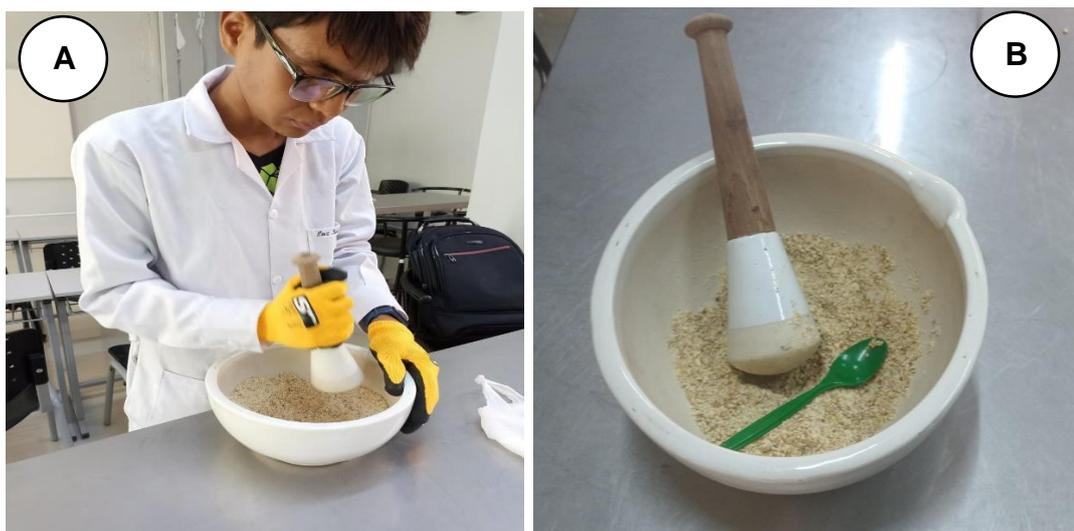
**Nota:** (A), proceso de trituración de las semillas de moringa *oleifera* (B), coagulante natural preparado para ser aplicado al test de jarras.
