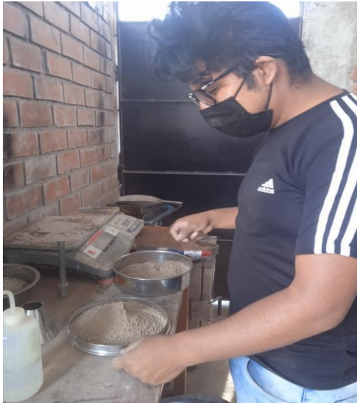
FOTO 5. OBTENCION DEL FILLER – MALLA Nº 200
