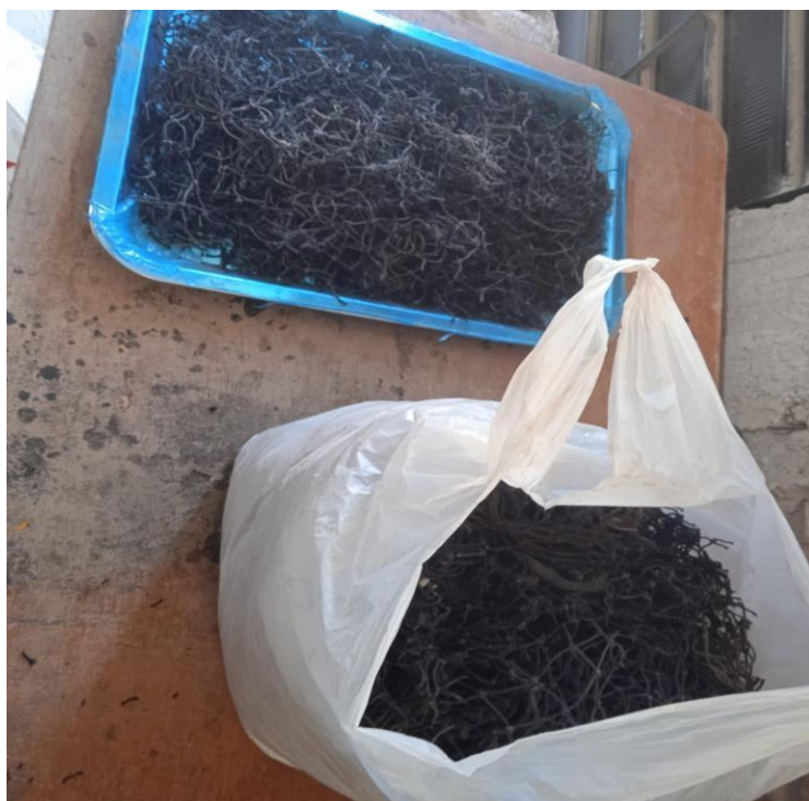
Figura N° 6. Se visualiza las poliamidas – redes de pesca elaborados de nylon.
