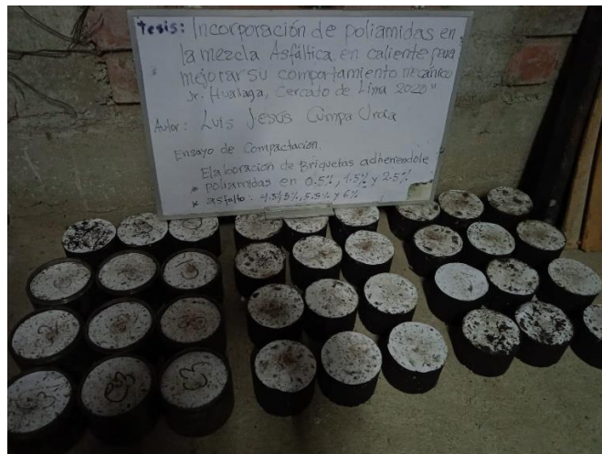
Figura N° 12. Se visualiza las 36 briquetas con poliamidas.
