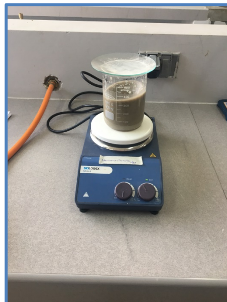
Fotografía 10: Dosis de 20 g de montmorillonita llevado al agitador magnético por un tiempo de 30 min NOTAS: Todas las dosis fueron agitadas al mismo tiempo
