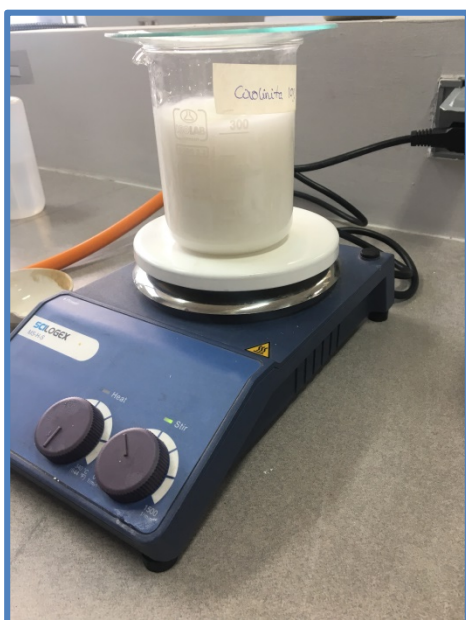
Fotografía 11: Dosis de 10g de caolinita llevado al agitador magnético por un tiempo de 30 min
