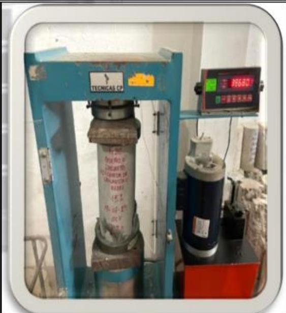
Fotos nº 39-40: En las imágenes podemos observar la resistencia a la compresión axial de los testigos de concreto
