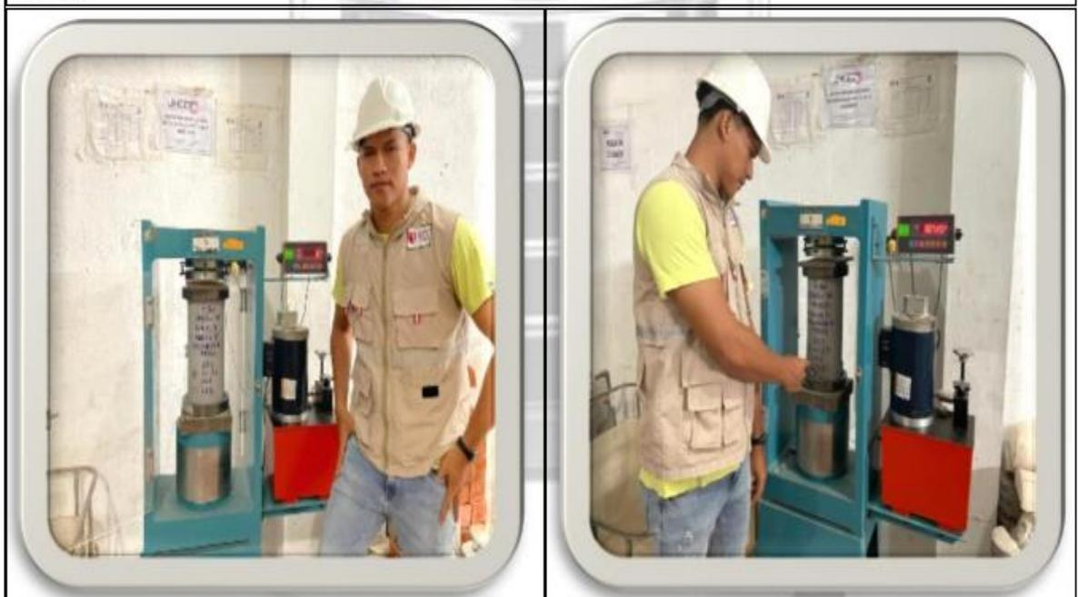
Fotos nº 31-32: En las imágenes podemos observar la resistencia a la compresión axial de los testigos de concreto
