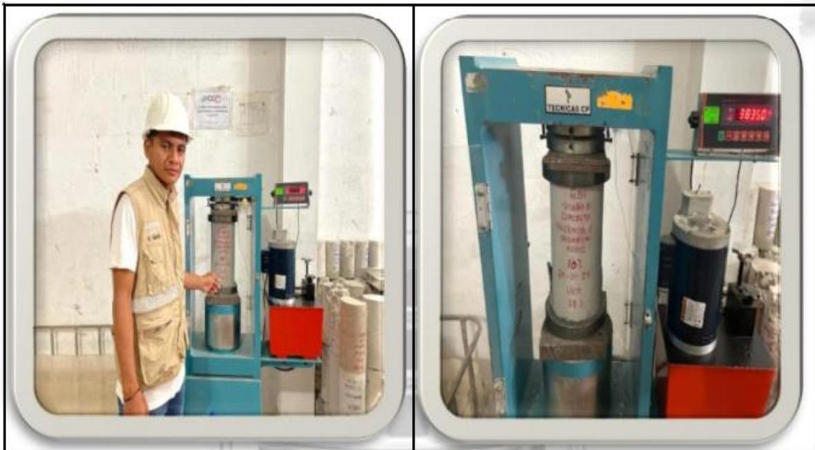
Fotos nº 33-34: En las imágenes podemos observar la resistencia a la compresión axial de los testigos de concreto
