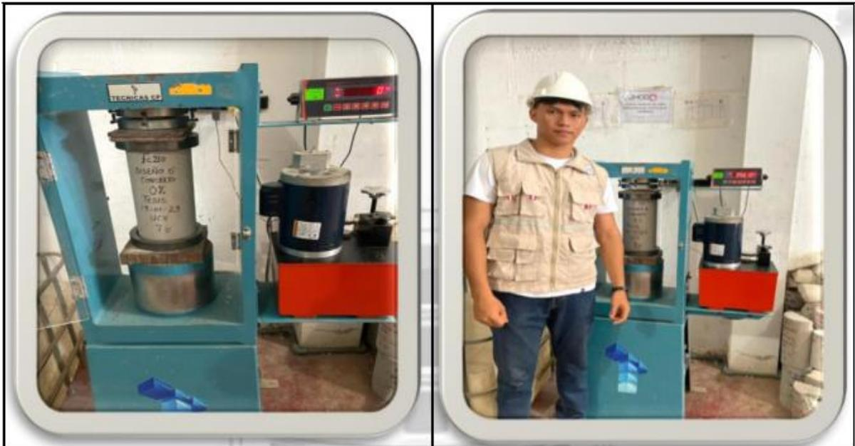
Fotos nº 17-18: En las imágenes podemos observar la resistencia a la compresión axial de los testigos de concreto de 7 días patrón.
