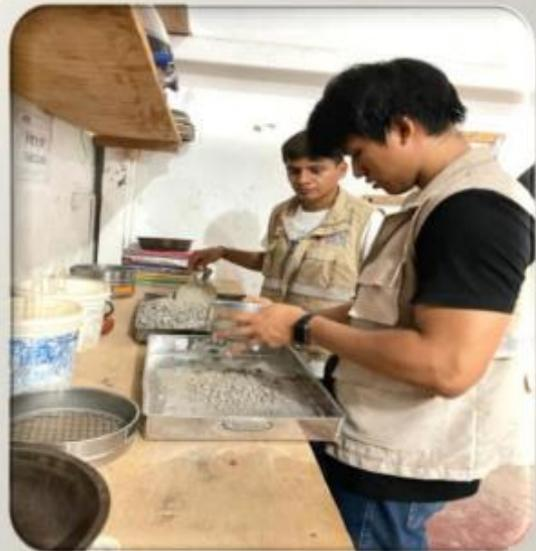
Fotos nº 03-04: En las imágenes se puede apreciar el ensayo de análisis granulométricos.
