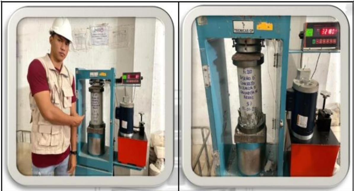
Fotos nº 25-26: En las imágenes podemos observar la resistencia a la compresión axial de los testigos de concreto
