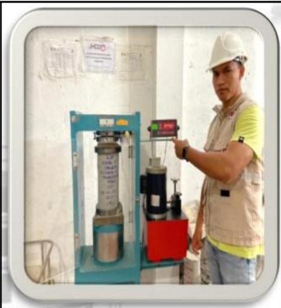
Fotos nº 37-38: En las imágenes podemos observar la resistencia a la compresión axial de los testigos de concreto
