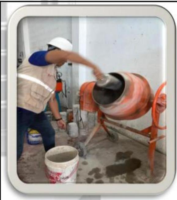
Fotos nº 11-12: En las imágenes podemos observar al personal realizando moldeo de los testigos de los diseños.
