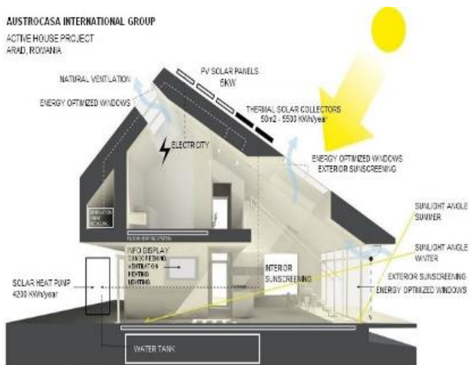
Figura 11. Inmueble aplicando sistemas sostenibles
