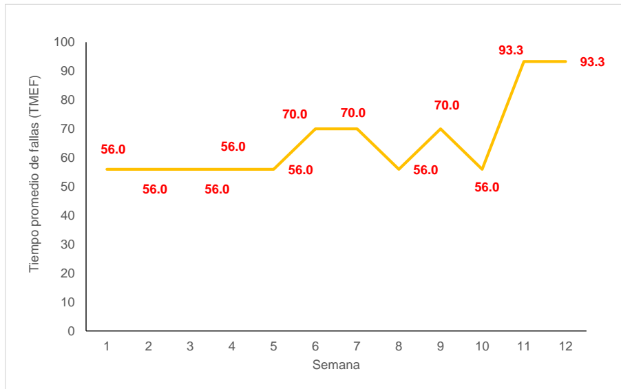
Figura 8. Tiempo promedio de fallas de los montacargas de la empresa - postest
