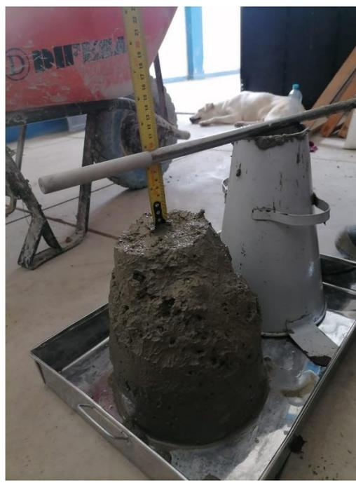
**Ensayo de para determinar la trabajabilidad del concreto
