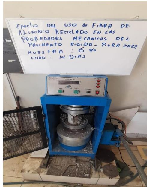
**Rotura de probetas de concreto en porcentajes de 0%, 2% 4% y 6%**
