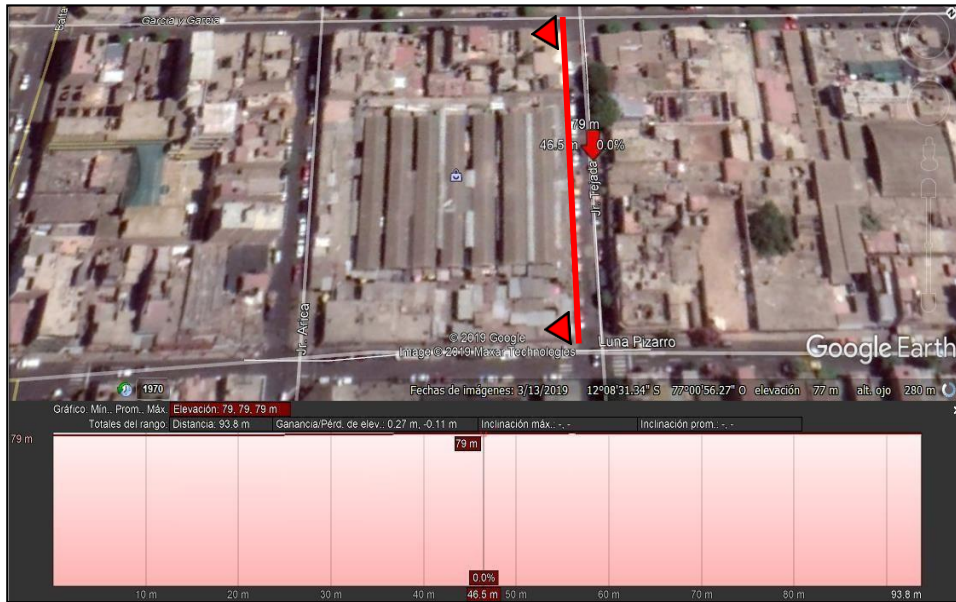
Figura 79: Perfil Topográfico P-3, del mercado N°2 de barranco
