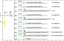
ESQUEMA UNIFILAR TABLERO T.D-403
