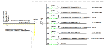
ESQUEMA UNIFILAR TABLERO T.D-601
