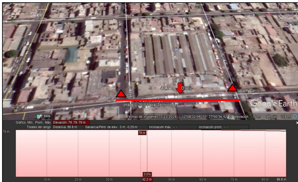
Figura 78: Perfil Topográfico P-2, del mercado N°2 de barranco Fuente: Google Earth 2020
