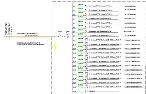
ESQUEMA UNIFILAR TABLERO T.D-402
