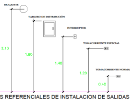
ALTURAS REFERENCIALES DE INSTALACION DE SALIDAS
