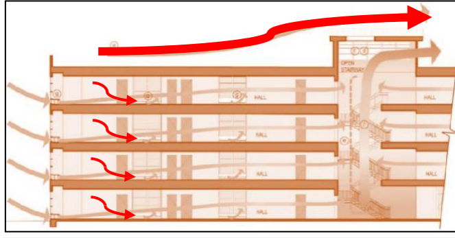
Figura 98: Ventilación cruzada en edificios comerciales
