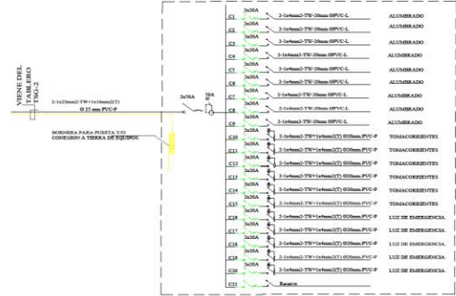
ESQUEMA UNIFILAR TABLERO T.D-402
