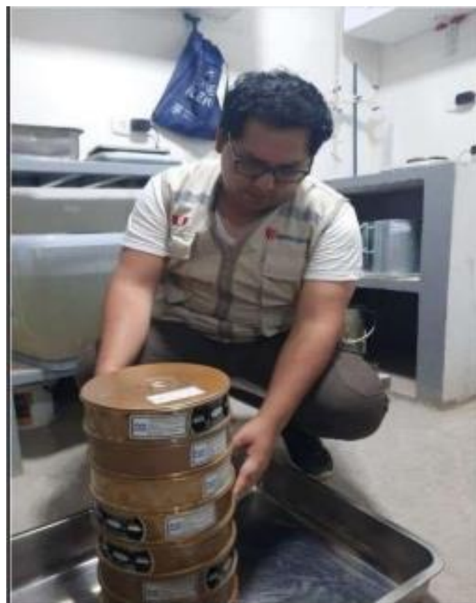
Figura 16. Análisis granulométrico de suelos por tamizado
