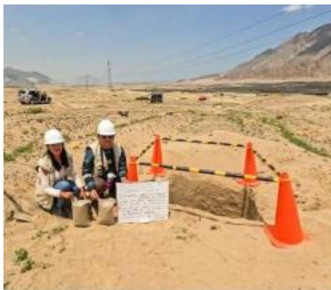
Figura 14. Cinco kilos de muestra extraída de las calicatas
