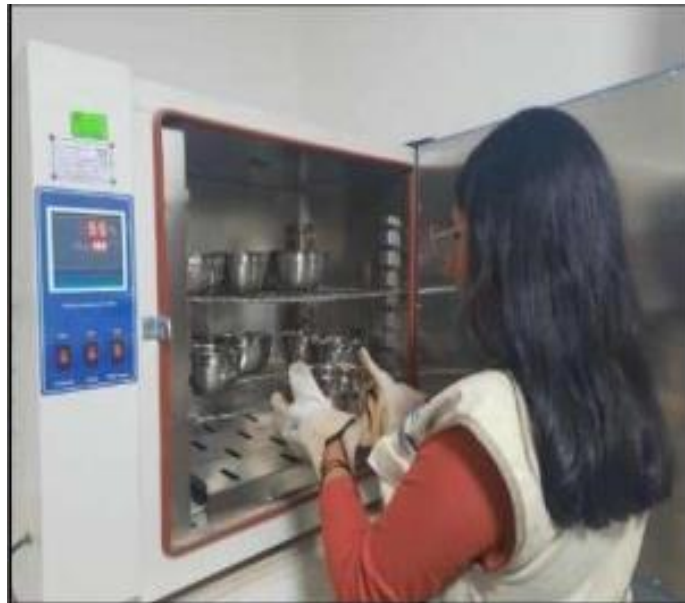
Figura 15. Colocando el recipiente con la muestra en el horno a una temperatura de 110 \pm 5\text{C}^\circ por un mínimo de 16 horas, pero para mayor efectividad sacar la muestra luego de 24h.
